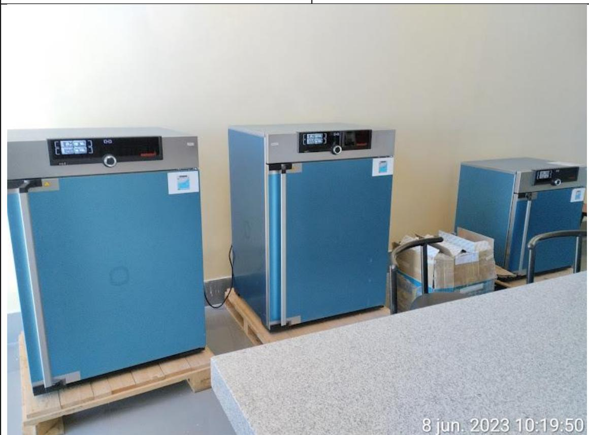
Imagen 30. Incubadoras condicionadas a 37°C, 27°C, 20°C
