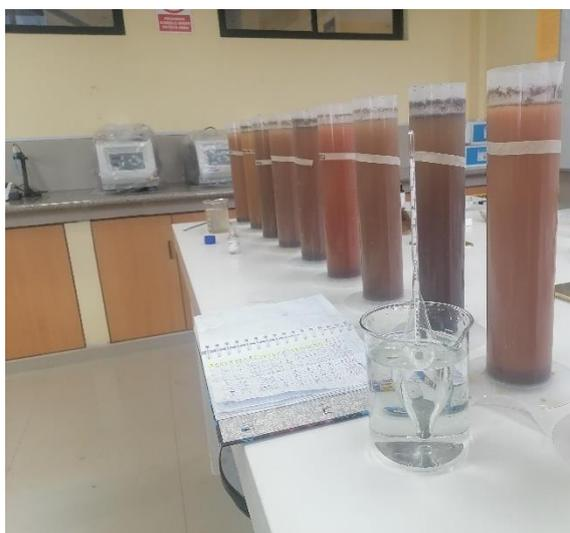
Probetas de 1000 ml con muestras de suelo.
