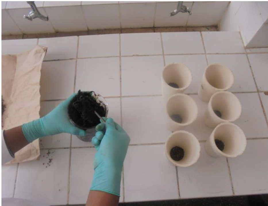
Lavado del carbón activado hasta llevar el pH a 7 aproximadamente
