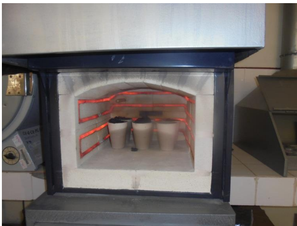
Equipo de Mufla para la obtención de carbón activado
