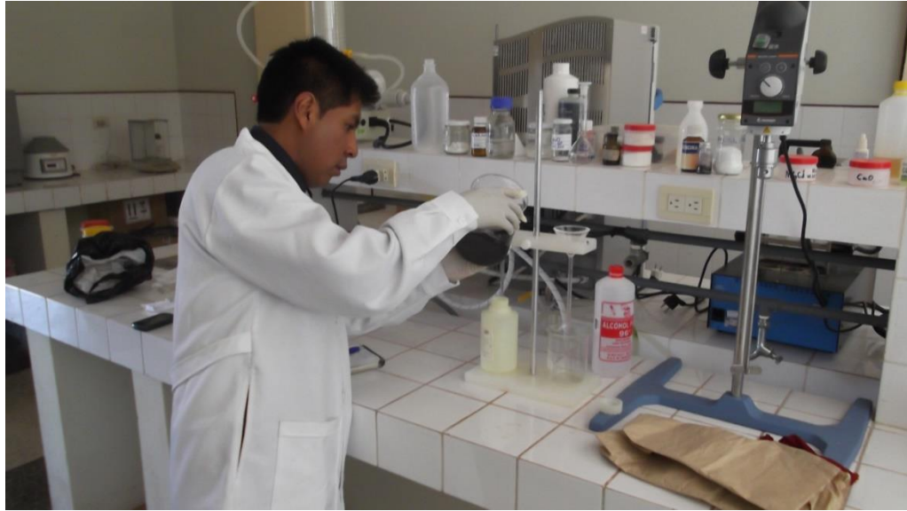
Adsorción de metales pesados y metales generales a través de columna de adsorción
