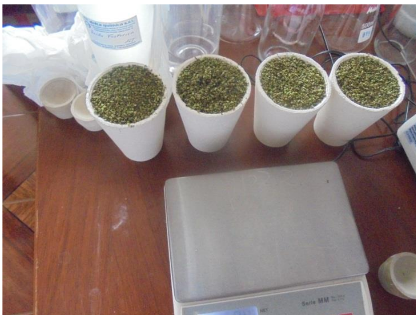
Impregnación de ácido fosfórico para la elaboración de carbón activado
