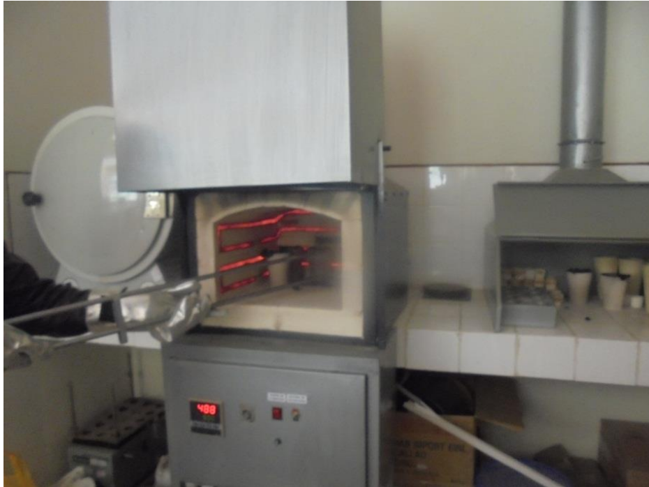
Obtención del carbón activado de 500°C a 600 °C
