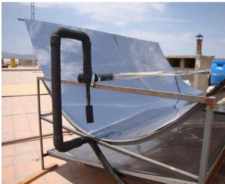
Figura 5. Vista general del destilador destacando la conducción de vapores hacia la placa condensadora
