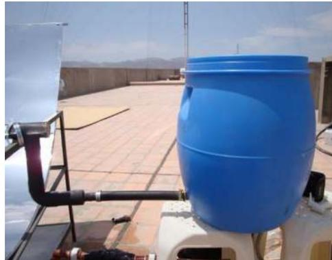
Figura 2. Tanque de alimentación de agua al destilador
