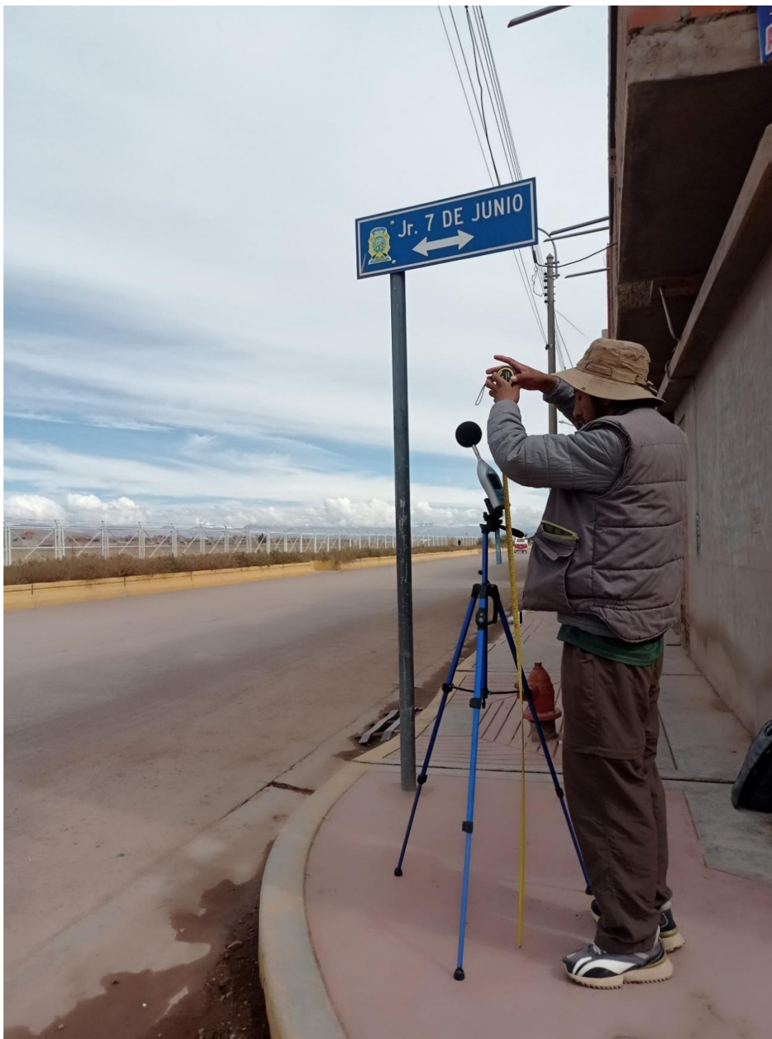
Figura 29.- Urb. el Carmen ajustando el sonómetro para el monitoreo de ruido de aviones
