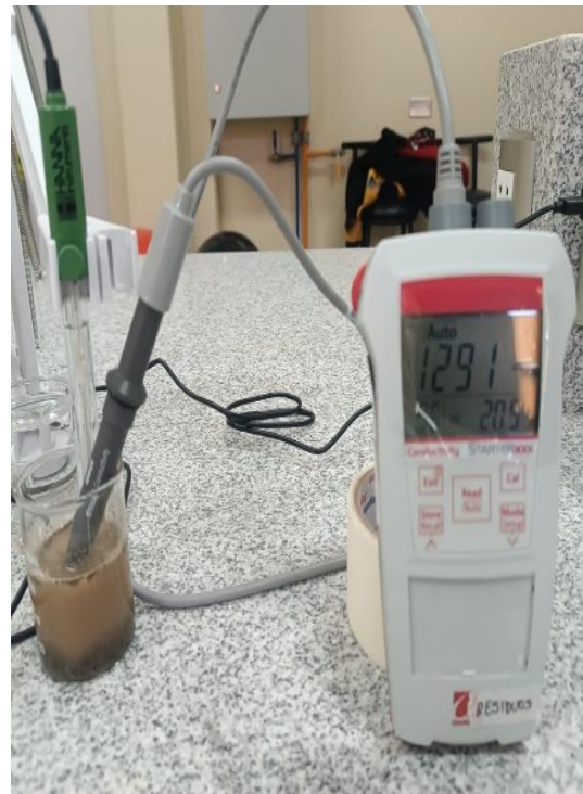
Figura 133. Medición de conductividad eléctrica del suelo.
