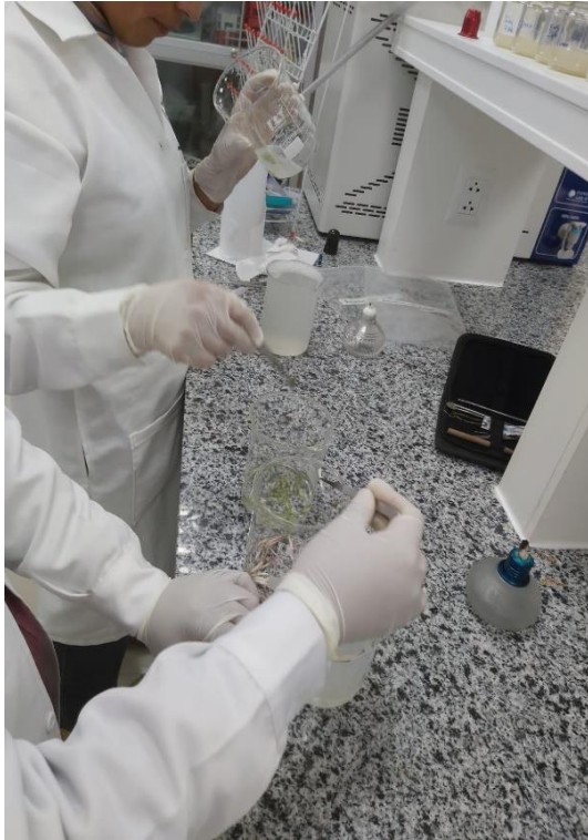
Figura 68. Desinfección de explantes con cloro, etanol al 70 % e hipoclorito de sodio.
