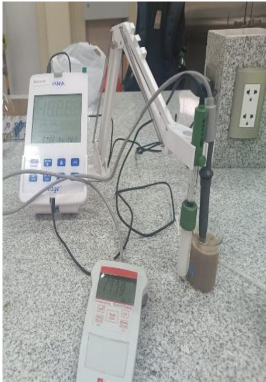
Figura 144. Medición de PH y conductividad eléctrica del suelo contaminado.
