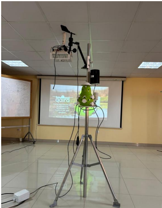
Foto 5 Equipo de monitoreo de calidad del aire.
