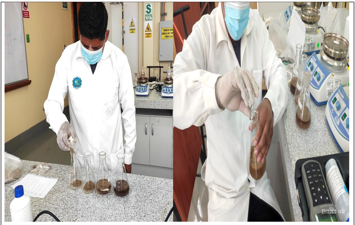
Figura 32. Mezcla del adsorbente Musa paradisiaca con la muestra de agua contaminada
