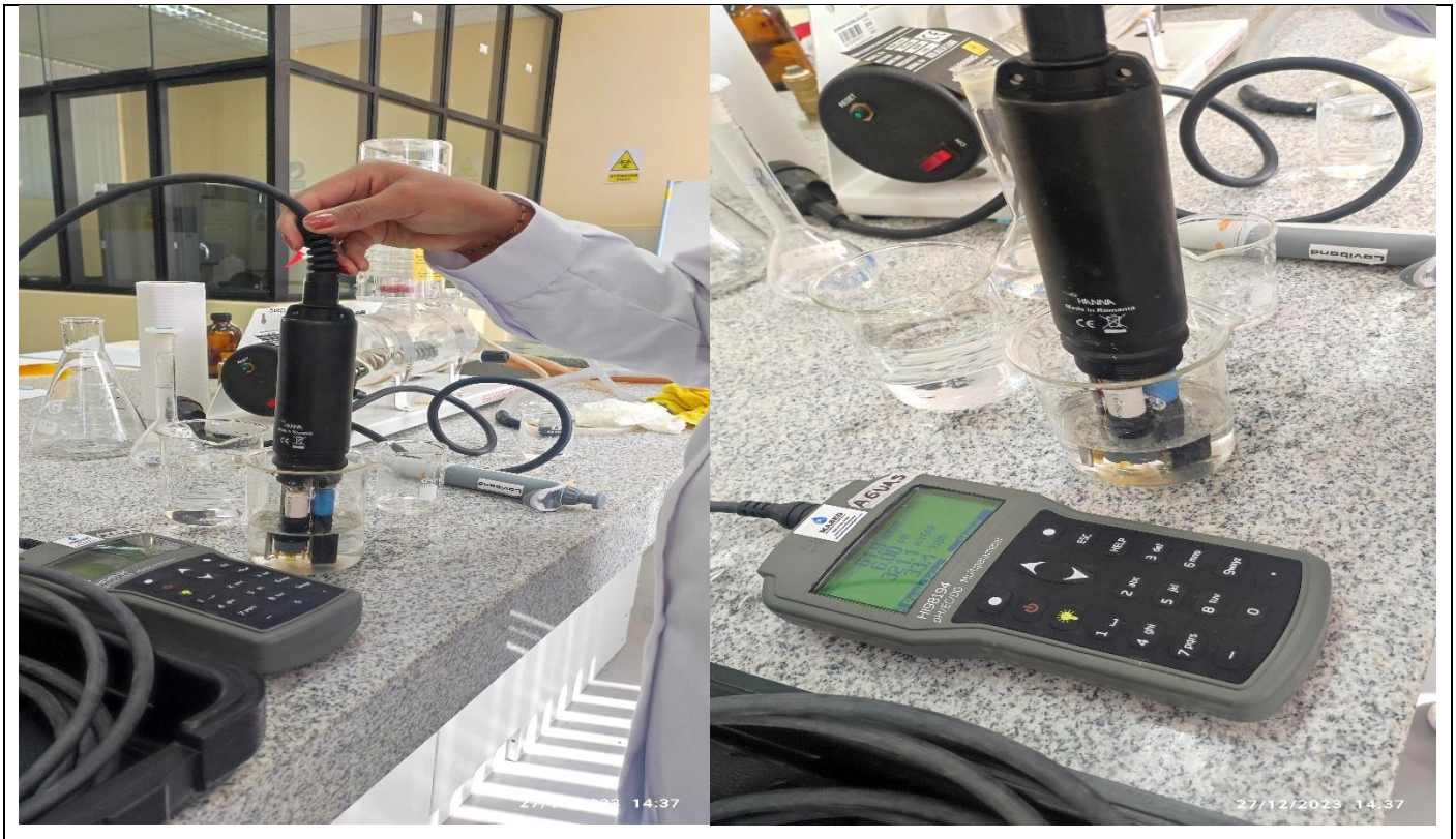
Figura 31. Variación del pH a 4 y 6 con hidróxido de sodio NaOH y ácido clorhídrico HCl a 0.1N
