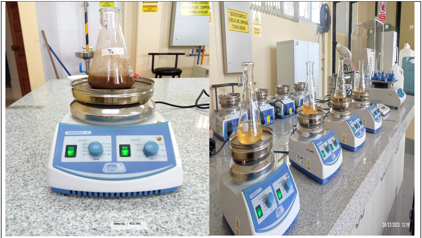
Figura 33. Primera y segunda agitación de la Musa paradisiaca y agua contaminada a 150 RPM durante 60 minutos a una temperatura de 16 \pm 2 °C
