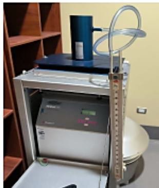
Fig 2. Calibración de Flujo del muestreador de Partículas HiVol
