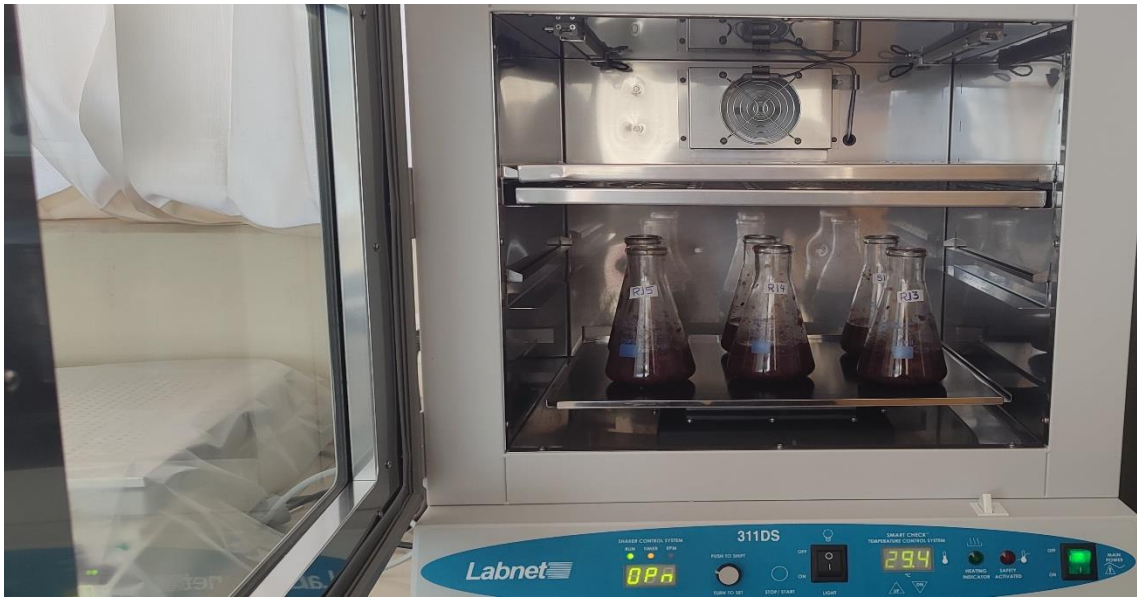
Figura 27: Fermentación de muestras en la incubadora con agitador orbital a 120 oscilaciones
