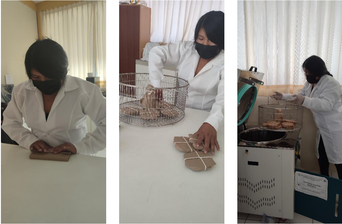
Figura 17: Esterilización de materiales de laboratorio para el cultivo
