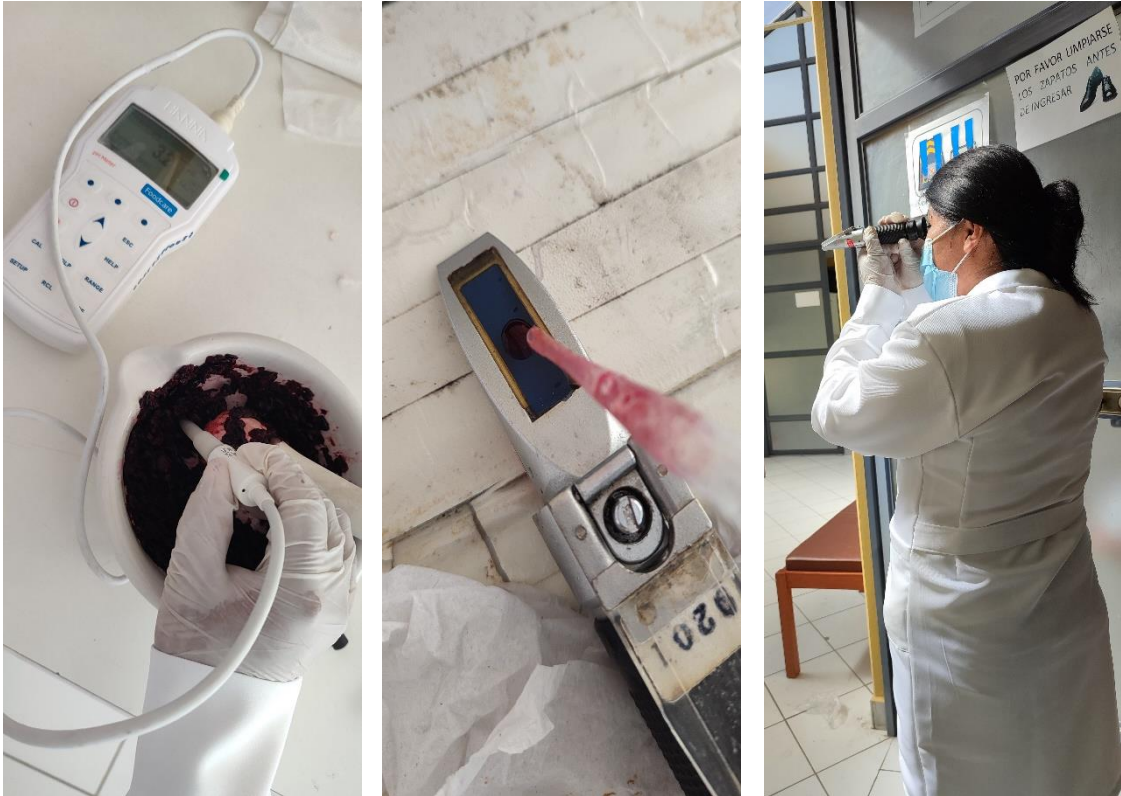
Figura 22: Medición del pH y grados °Brix
