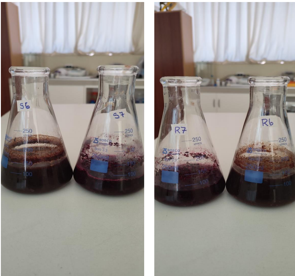
Figura 27: Fermentación de muestras en la incubadora con agitador orbital a 120 oscilaciones
