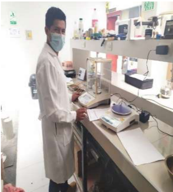
Figura 59. Peso de la madera seca para la determinación del peso específico básico de la madera
