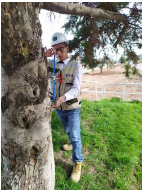
Figura 51. Extracción de muestras de madera con el barreno Haglof de tipo Pressler
