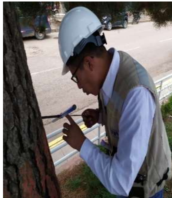
Figura 60. Extracción de tarugos de madera para el cálculo del peso específico básico de la madera
