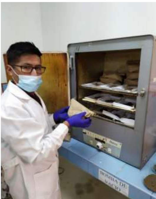
Figura 41. Secado de muestras en la estufa para la determinación de la densidad aparente
