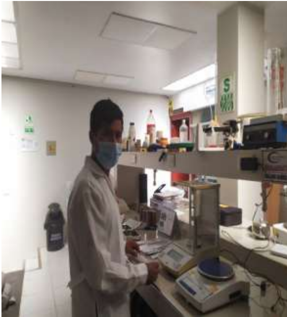
Figura 57. Pesado de la madera seca para la determinación del peso específico básico de la madera
