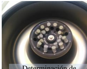
Determinación de sólidos en suspensión con centrifuga
