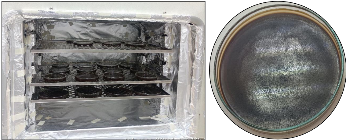
Anexo 17. Secado de nanopartículas a 70° durante 24 horas
