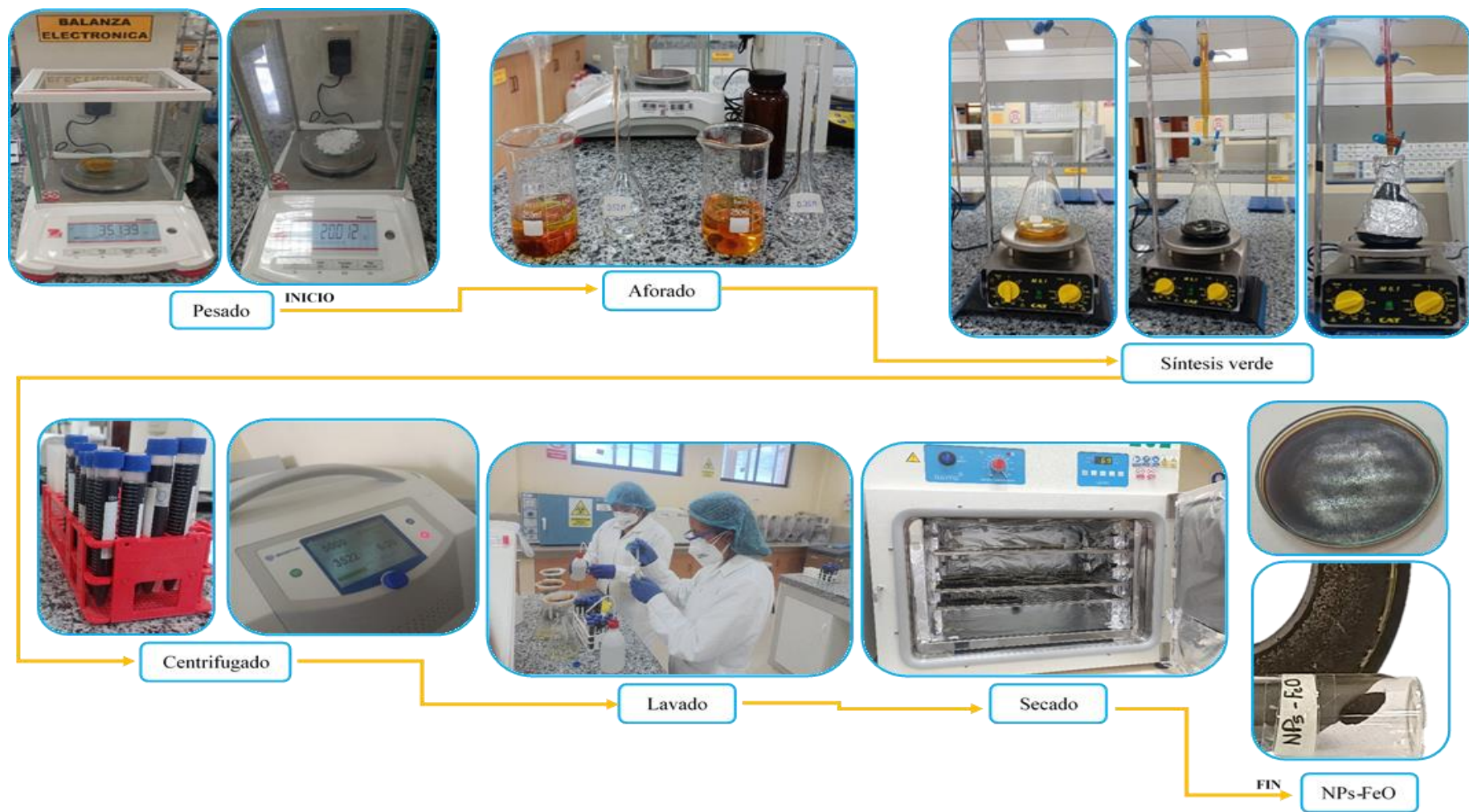
Figura 19. Sistema de síntesis de NPs-FeO
