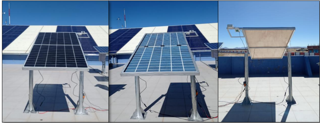
Figura 29. Trazado de curvas I-V del lado frontal y reverso del módulo fotovoltaico bifacial.
