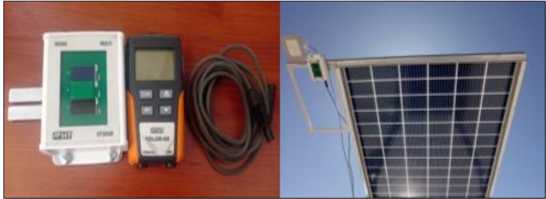
Figura 24. Celda calibrada para medir radiación solar en el reverso del módulo fotovoltaico bifacial.
