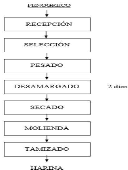
Figura 5 Diagrama del proceso obtención de harina de fenogreco.
