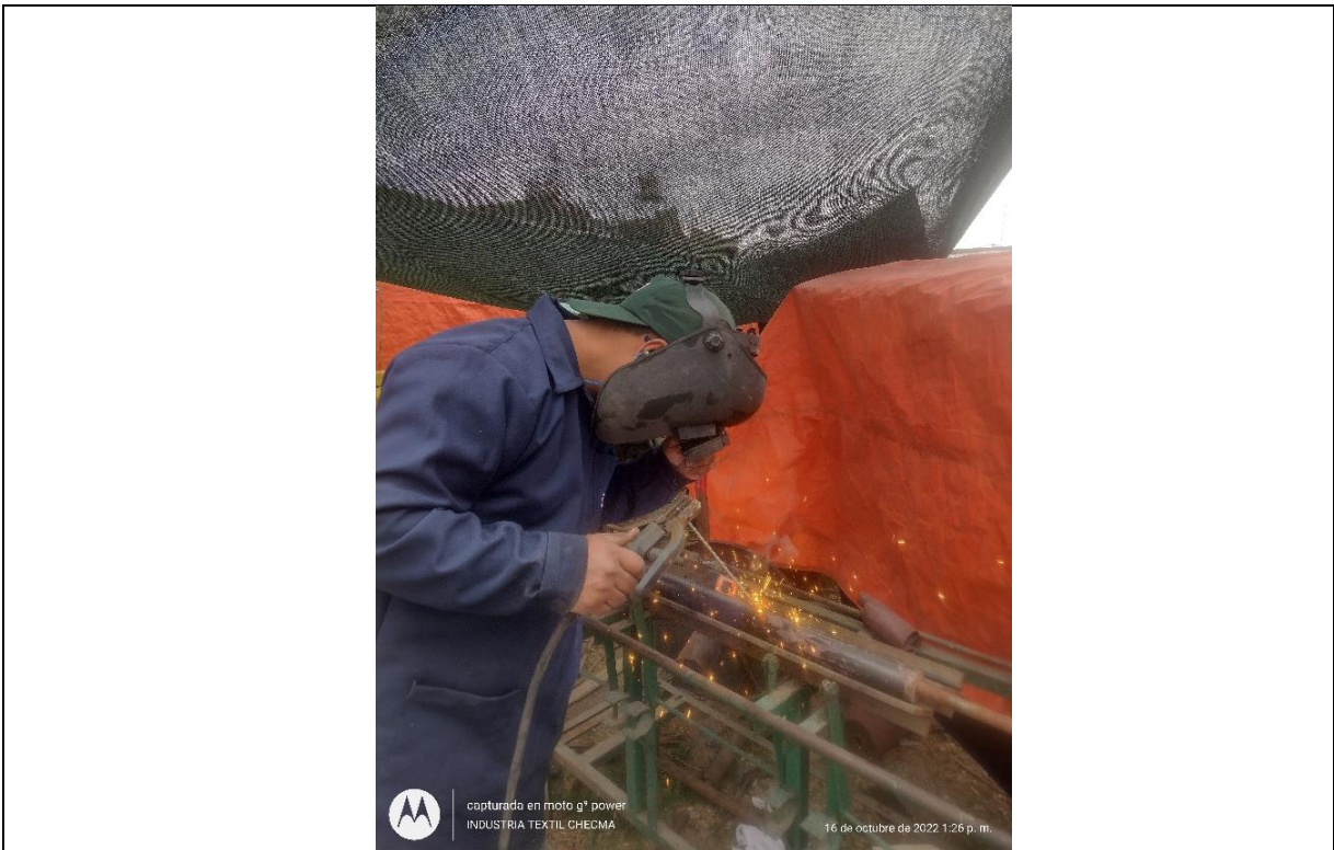
Unión de las piezas metálicas mediante soldaduras
