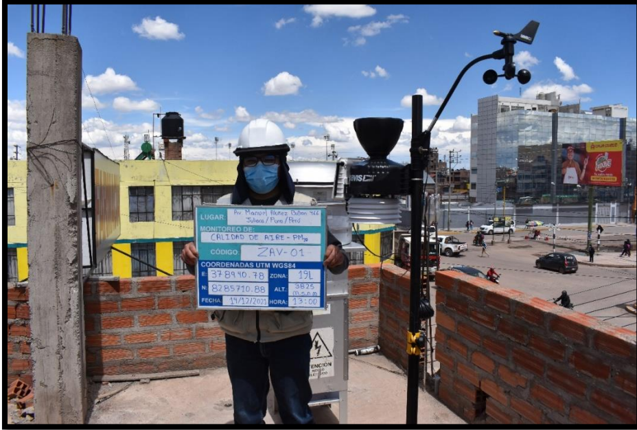
Imagen N° 07.- Monitoreo de material particulado menor a 10 micras y condiciones meteorológicas en la zona de alto tránsito vehicular – ZAV – 1, en dirección Av. Manuel Núñez Butrón N° 522 (Salida Puno), de fecha 14/12/2021.
