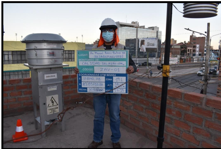
Imagen N° 04.- Monitoreo de material particulado menor a 10 micras y condiciones meteorológicas en la zona de alto tránsito vehicular – ZAV – 1, en dirección Av. Manuel Núñez Butrón N° 522 (Salida Puno), de fecha 30/08/2021.
