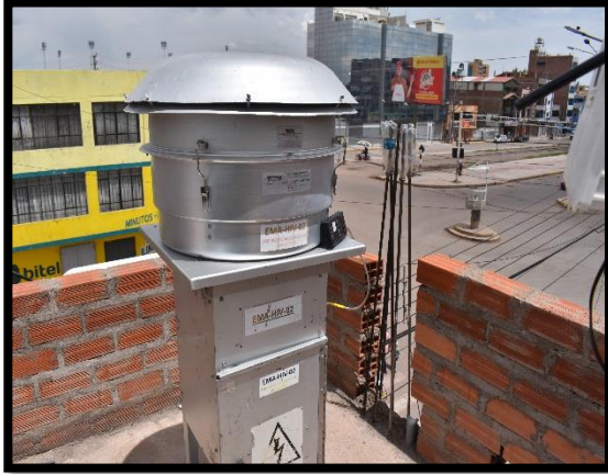
Imagen N° 13.- Muestreador de alto volumen (High Vol) de la empresa Moneco S.A.C, para el monitoreo del material particulado menor a 10 micras PM 10
