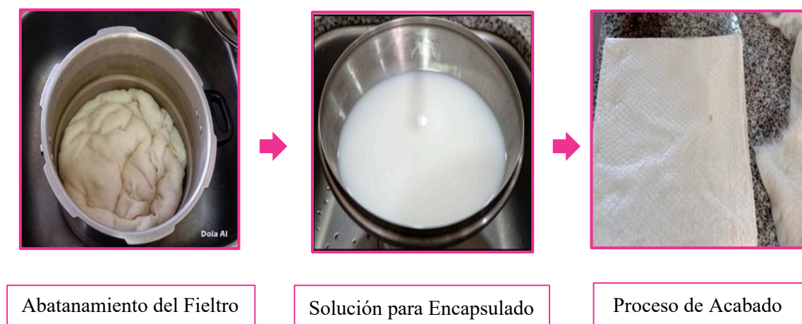
Figura 15. Proceso de elaboración de las plantillas ecológicas
