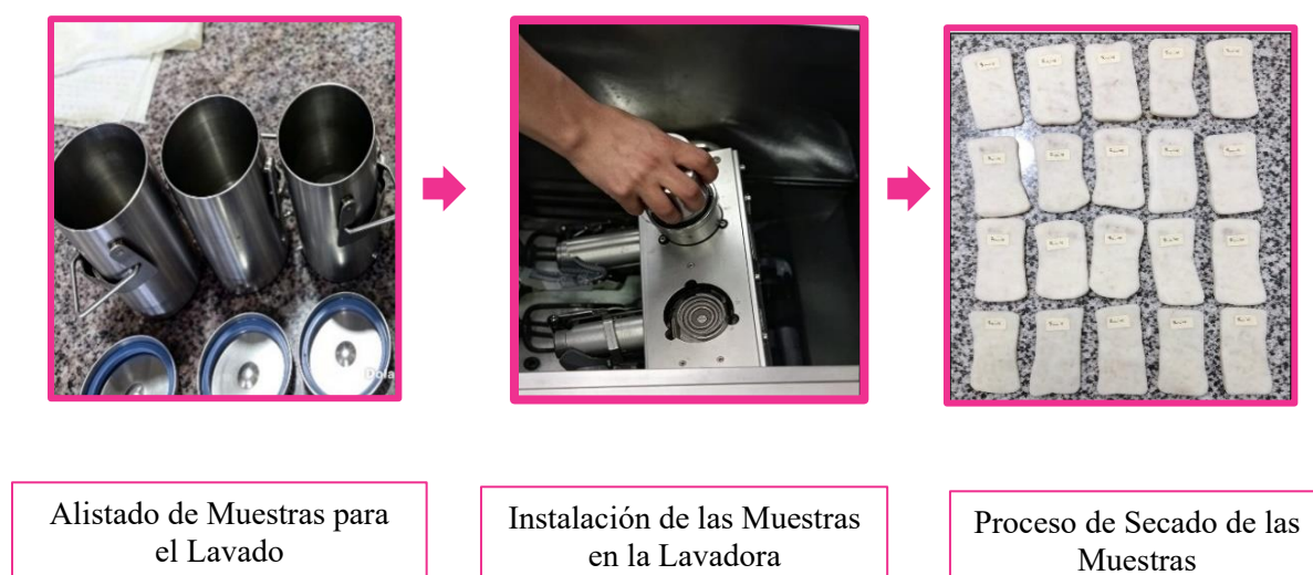
Figura 21. Ejecución de la prueba de lavado.
