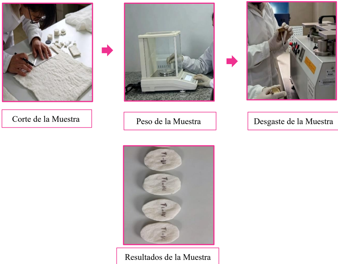
Figura 19. Ejecución de la prueba de la abrasión
