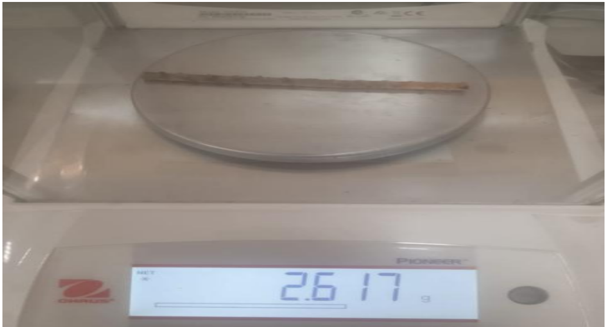
Figura 39. Pesado de las muestras de madera secado al horno para la determinación de peso específico básico de la madera
