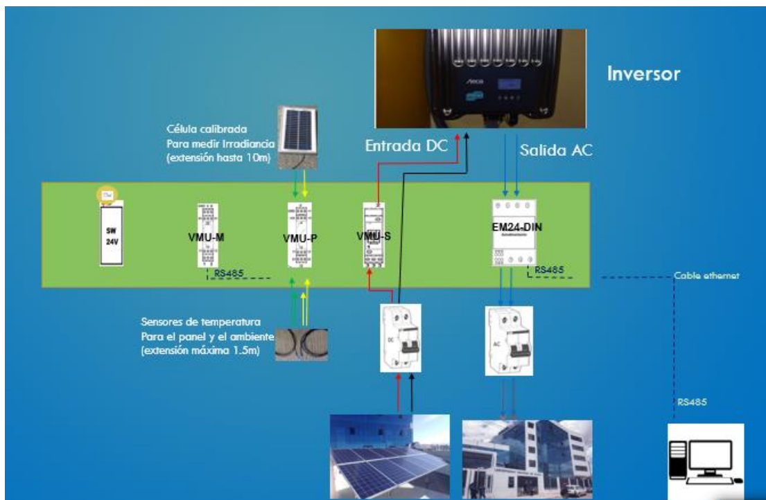
Figura 22. Arquitectura del sistema de monitorización
