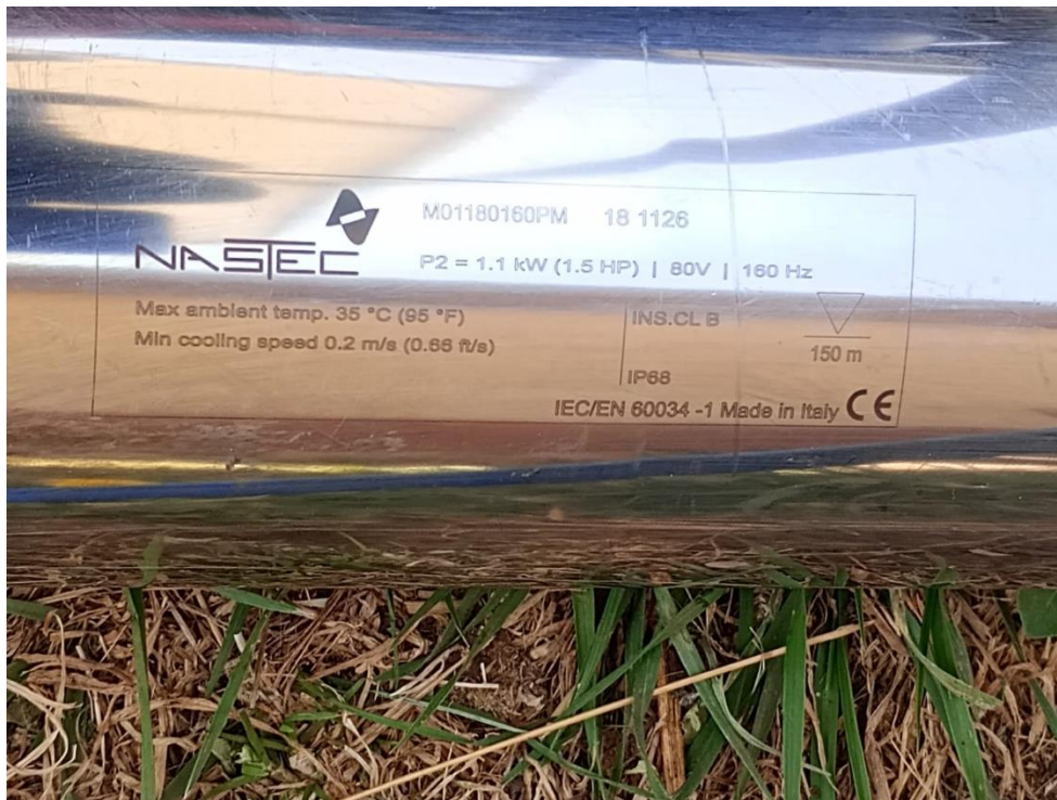
Anexo 13. Parte del motor de la bomba sumergible Nastec Multipower
