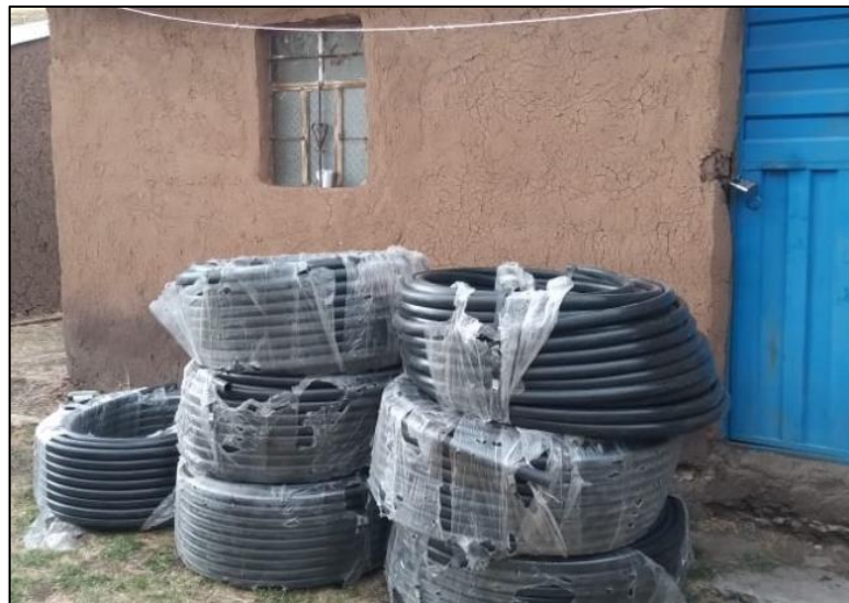
Figura 24. Mangueras de polietileno HDPE para el trayecto.
