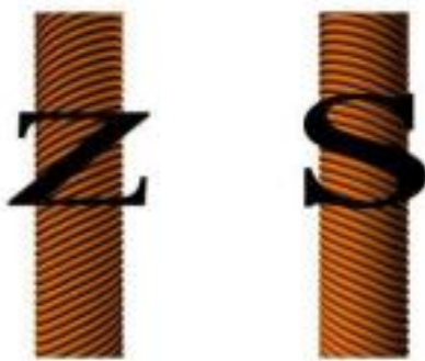
Figura 13: Torsión “Z” y “S” de los hilos
