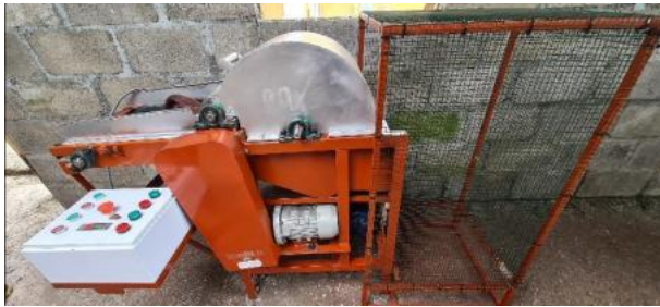
Figura 9: Abridora eléctrica de pelo de alpaca
