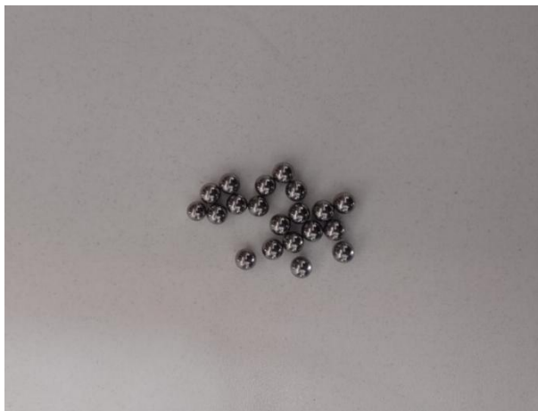
Figura 54: Billas de acero inoxidable de 6 mm de diámetro
