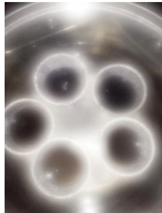
Figura 32: Preparación de solución al 6.6% a 60°C
