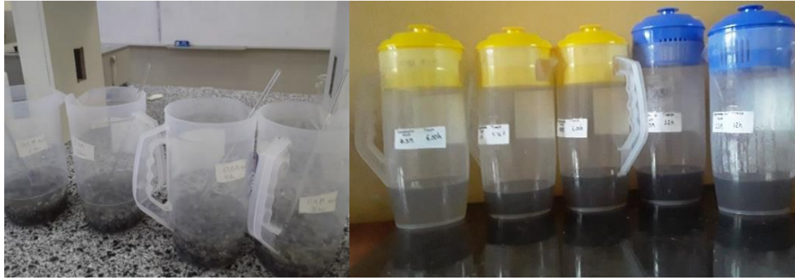
Figura 23: Hidrolisis a diferentes tiempos y concentraciones de NaOH
