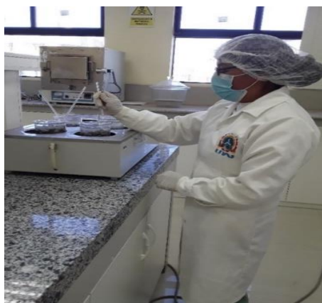
Figura 26: Tratamiento térmico de colágeno a 60°C en baño maría por 180 min
