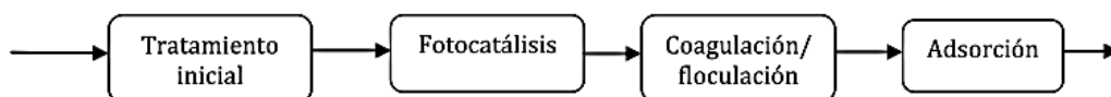
Figura 3. Eliminación de arsénico: adaptado de Hernández, Sanz, & Mancebo, 2014. Tratamiento de bajo coste para aguas contaminadas por actividades de minería, p. 41.
