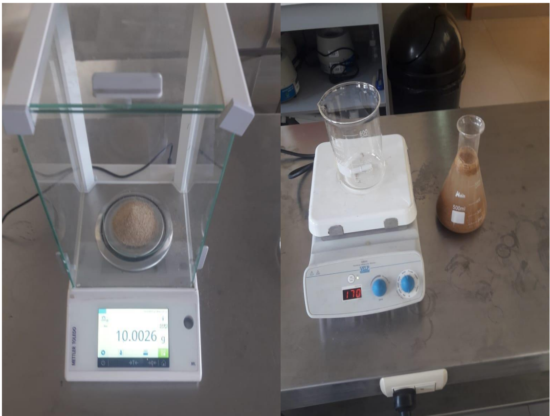
Figura 24. Pesaje de la cáscara de arroz para el acondicionamiento con el compuesto químico.
