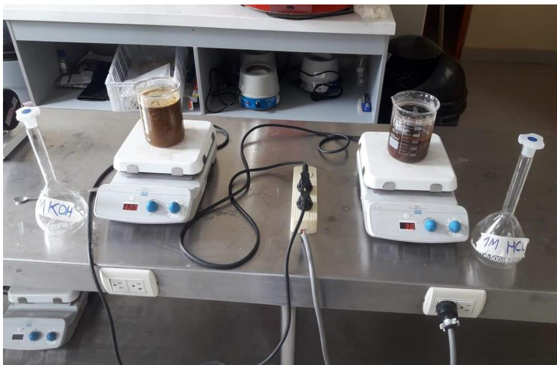
Figura 25. Estimación de la capacidad de remoción en un tiempo determinado con los compuestos químicos de Hidróxido de Potasio y Ácido Clorhídrico.
