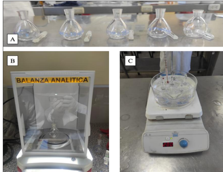
Figura 43. Determinación de la densidad. A: preparación de los picnómetros. B: peso del picnómetro vacío. C: muestra del agua sometida a calor.
