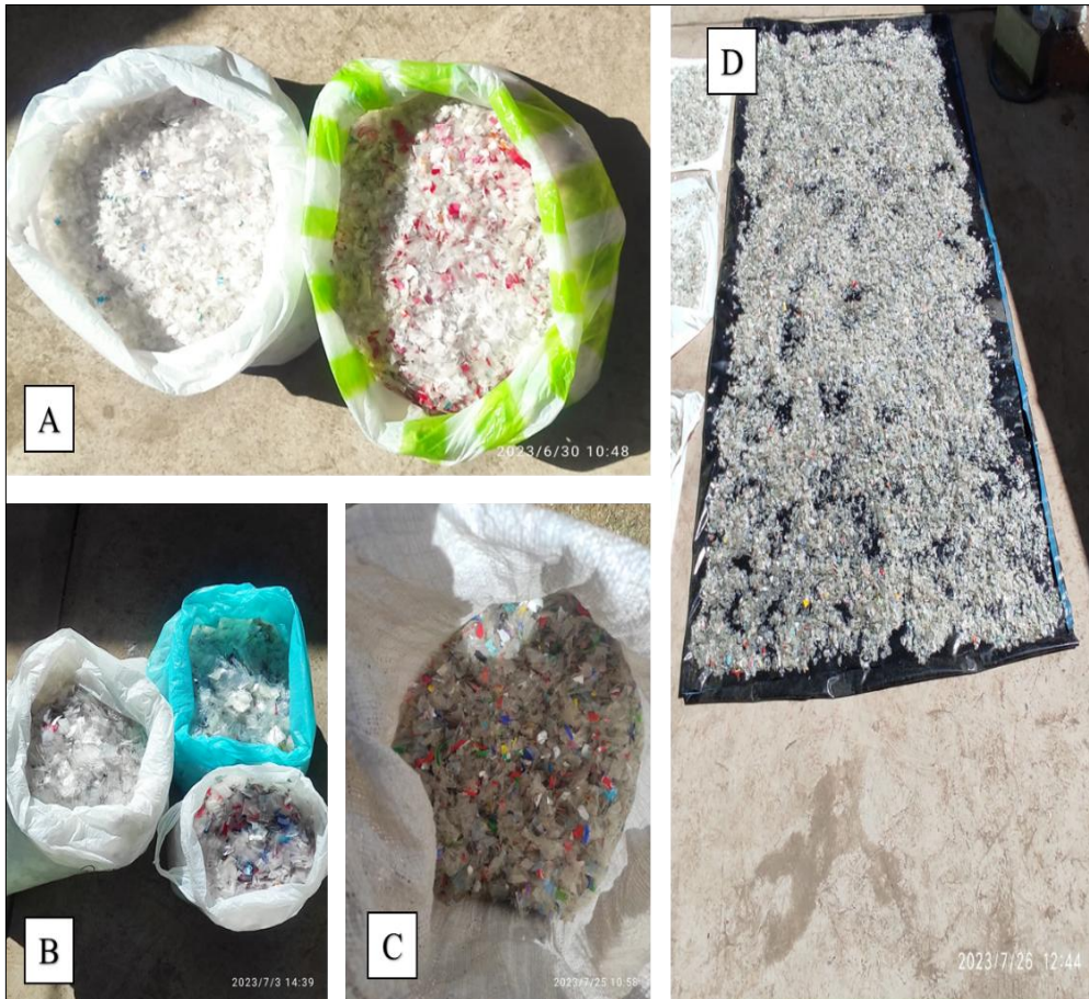
Figura 39. Pretratamiento de los residuos plásticos. A: picado del PEBD de 0-5 mm. B: picado del PEBD de 5-10 mm. C: picado del PET de 0-5 mm. D: proceso de secado después del lavado de los residuos.
