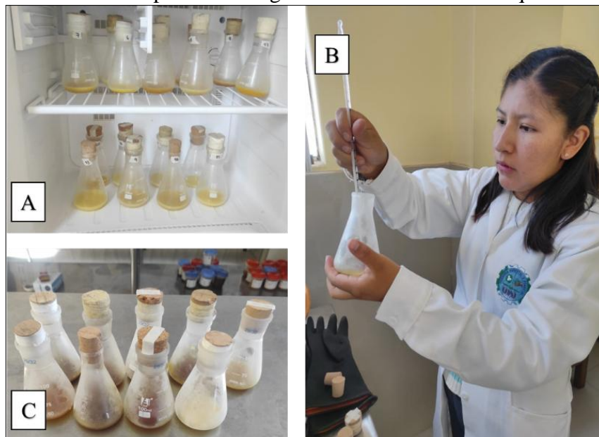
Figura 48. Punto de congelación. A: colocación de las muestras en la refrigeradora. B: medición de la temperatura. C: muestras congeladas retiradas de la refrigeradora.
