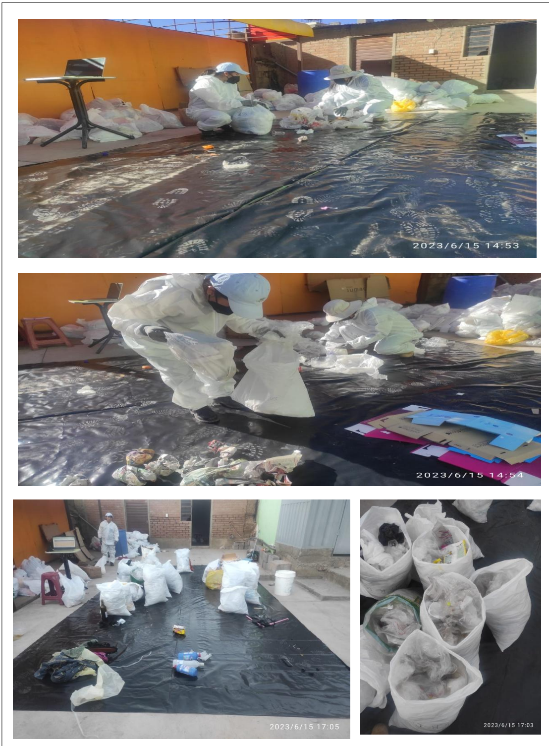
Figura 35. Determinación de la composición física A y B: segregación de los residuos sólidos. C: separación de los residuos sólidos por su composición. D: pesaje por tipo de residuo.
