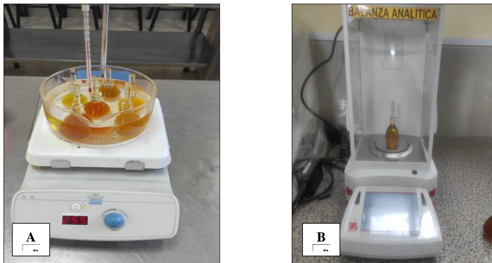
Figura 44. Determinación de la densidad del PEBD. A: muestras sometidas al calentador. B: peso de la muestra a 30°C.
