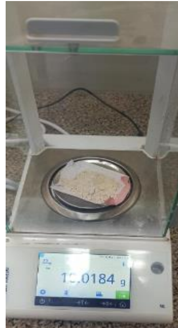
Peso de la muestra para medir la temperatura de gelatinización
