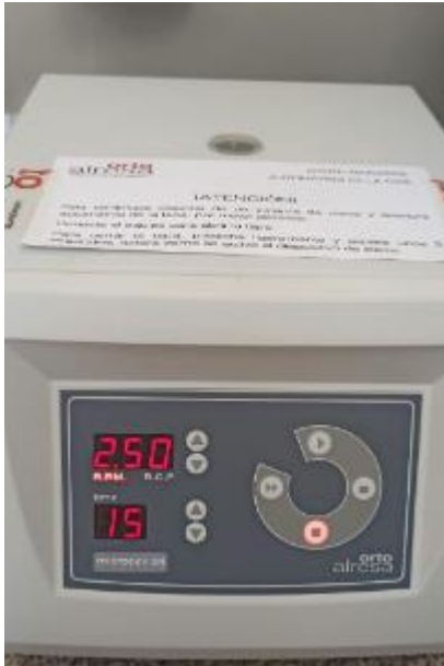
El gel se centrifuga a 2500 rpm por 15 min
