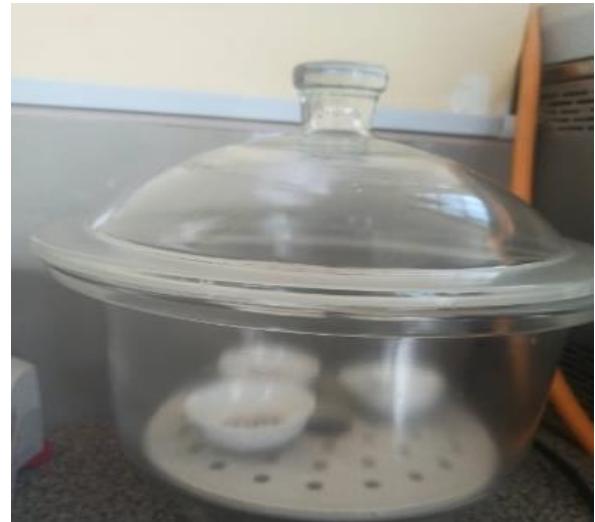
Enfriado de los crisoles con las muestras de almidón
