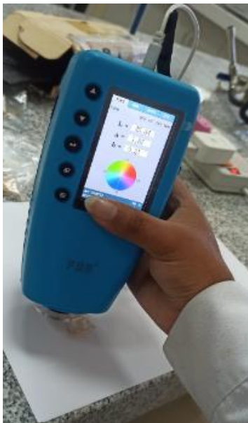
Medida de las coordenadas del sistema CIELab a las biopelículas
