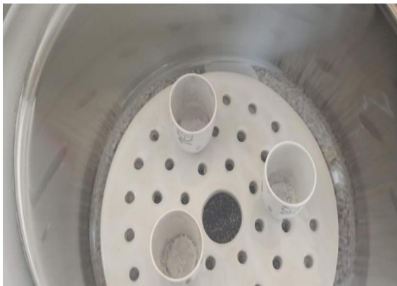
Enfriado de los crisoles con muestra para las cenizas
