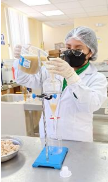
Agregado de la mezcla ya filtrada al equipo de decantación
