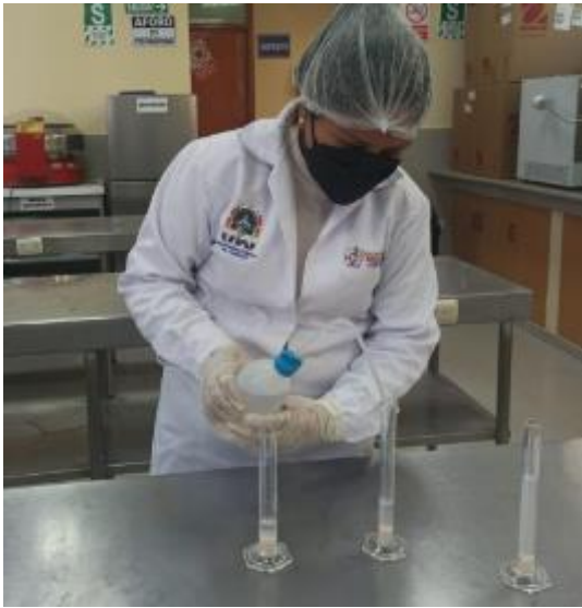
Almidón suelto más volumen total completado para medir la densidad
