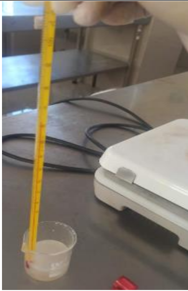
Calentado a 60°C y agitado por 30 min.
