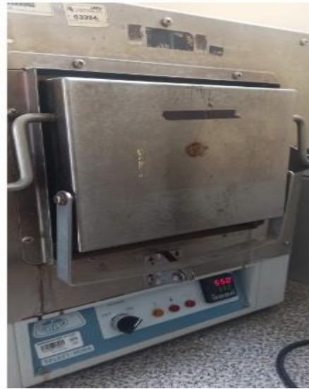
Incineración en la mufla de los crisoles con muestra para la obtención de las cenizas
