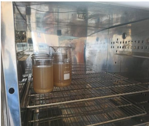
Agregado de la mezcla ya filtrada al equipo de decantación
