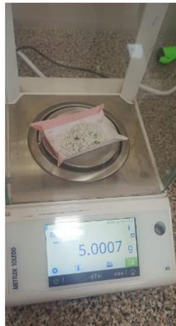
Pesado de la muestra de almidón para determinar su humedad
