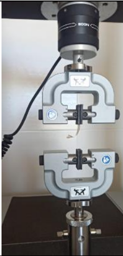
Ruptura de la muestra de biopelícula
