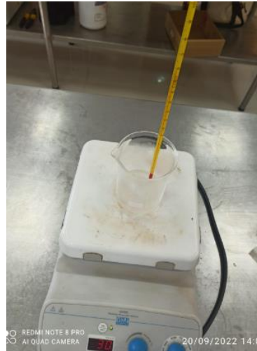
La suspensión se agito por 30 min a 60°C para la ISA
