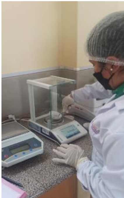
Pesado de los crisoles con la muestra enfriada
