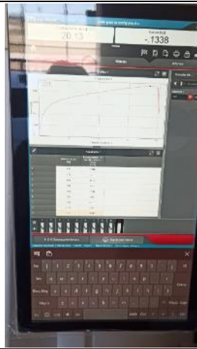
Obtención de los datos de máxima fuerza y desplazamiento
