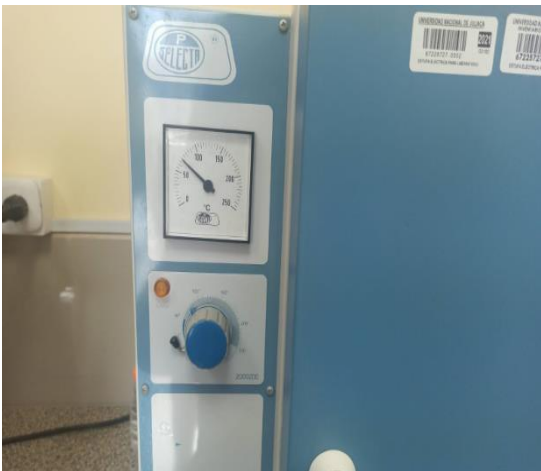
Secado de las muestras de almidón a 80°C
