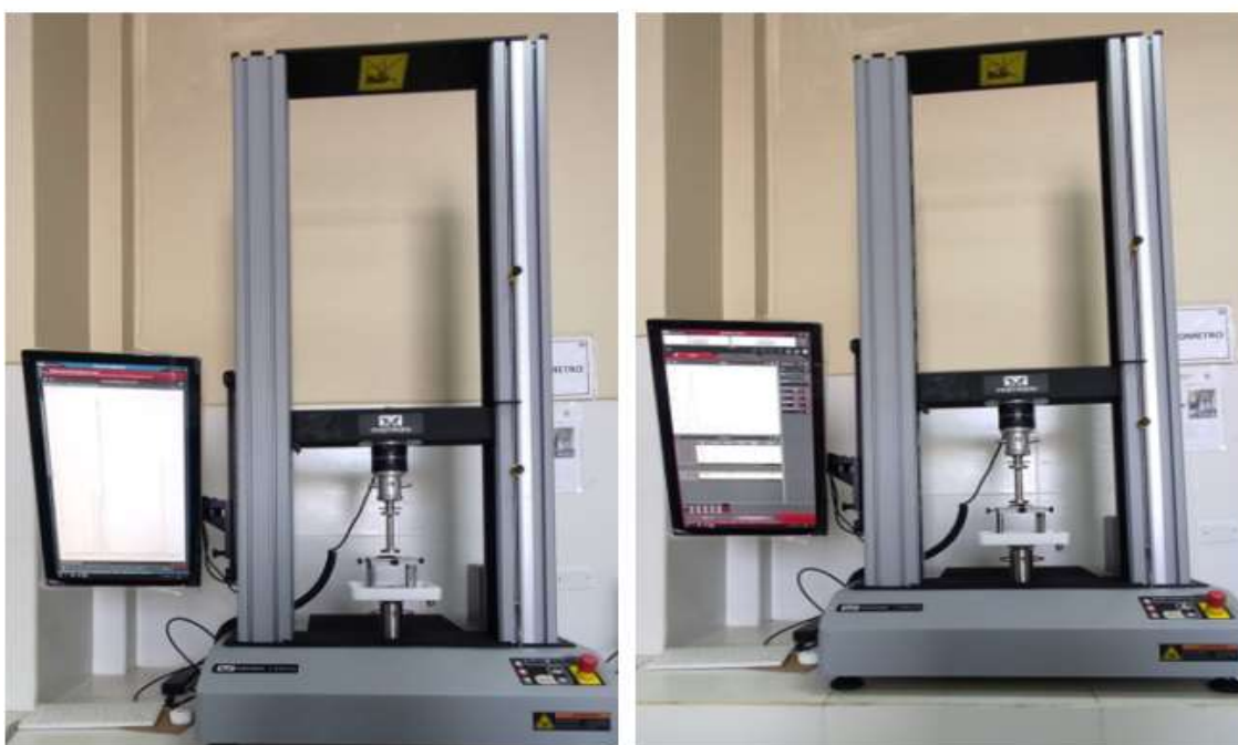
Figura 17: Equipo usado para la obtención de datos de dureza y fracturabilidad
