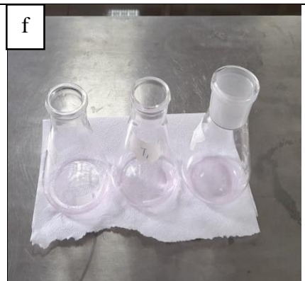
Determinación de la acidez: (d) muestras, (e) equipo de titulación, (f) muestras luego del análisis
