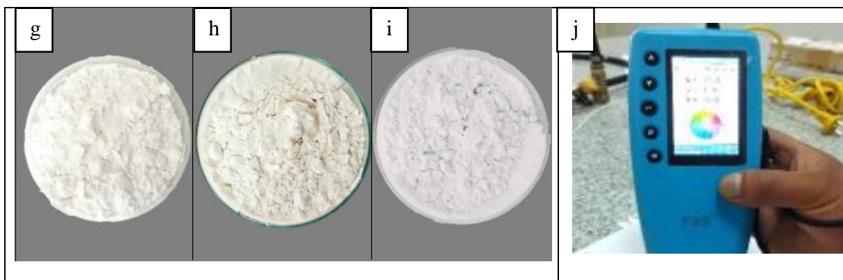
Determinación del índice de blancura: muestras de almidón (g) oca, (h) kaya, (i) uma kaya y (j) colorímetro
