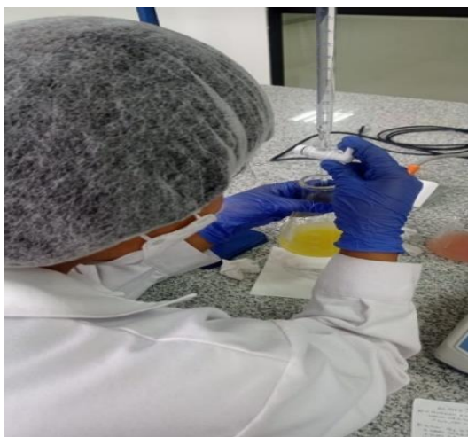
Titulación del aceite para determinar el índice de acidez y peróxido.
