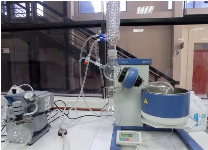
Proceso de destilado de la solución hexano – aceite, en un rotavapor.
