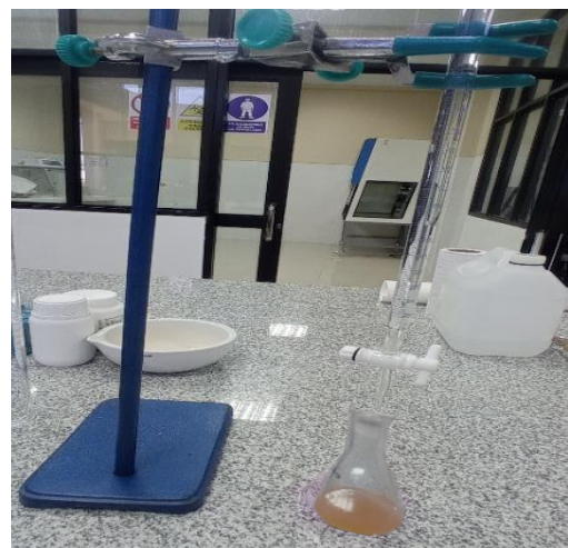
Titulación del aceite para determinar el índice de acidez y peróxido.
