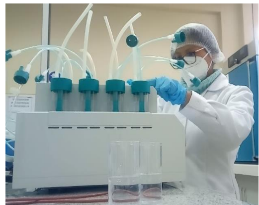
Agregando 60 ml de agua destilada a los vasos de polietileno y posteriormente se colocaron los vasos en el lugar correspondiente en el Rancimat.
