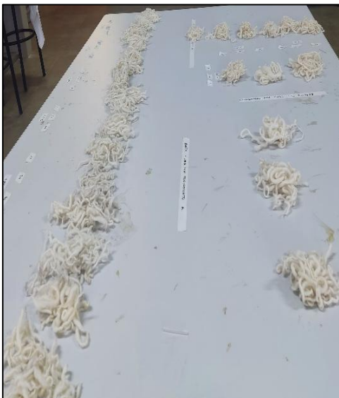
Residuos de cada hilo seleccionadas por cada tratamiento con aceite esencial de muña y hebras sin el tratamiento aplicado
