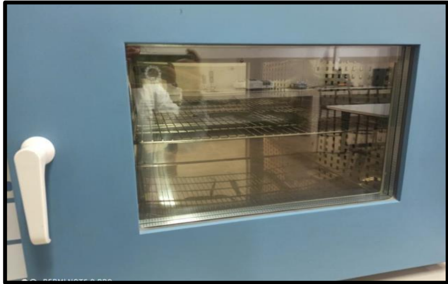
Figura 9. Secado en la estufa eléctrica de la cáscara de la sábila
