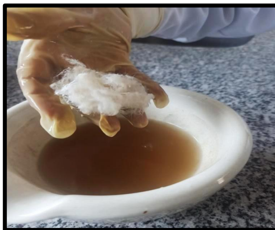
Figura 36. Lavado de la fibra de alpaca con el tercer detergente
