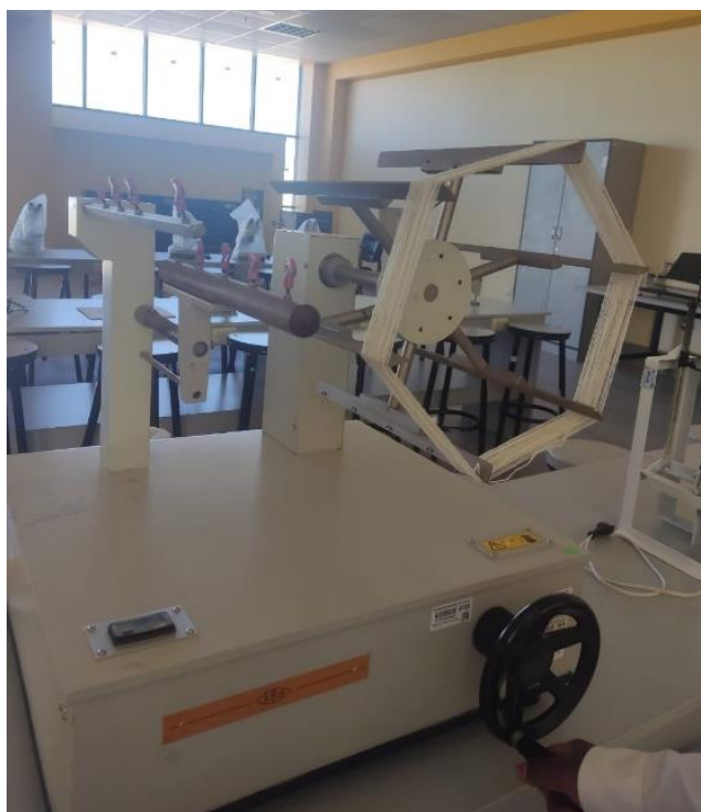
Madejado de hilos de ovino
