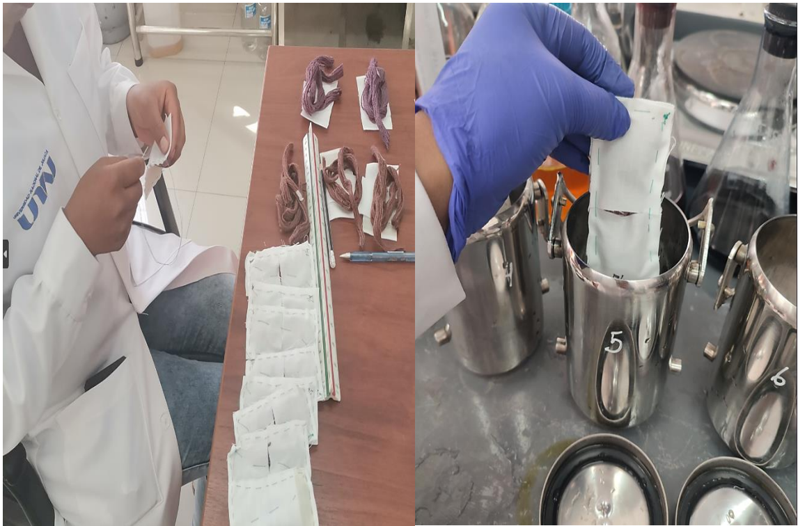
Preparación de muestras, colocación en los recipientes para realizar la solidez de color al lavado.
