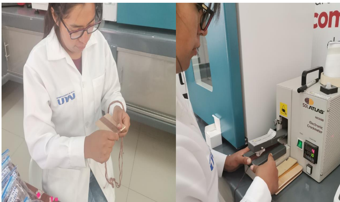
Preparación de muestras y realización de la solidez de color al frote en el equipo.
