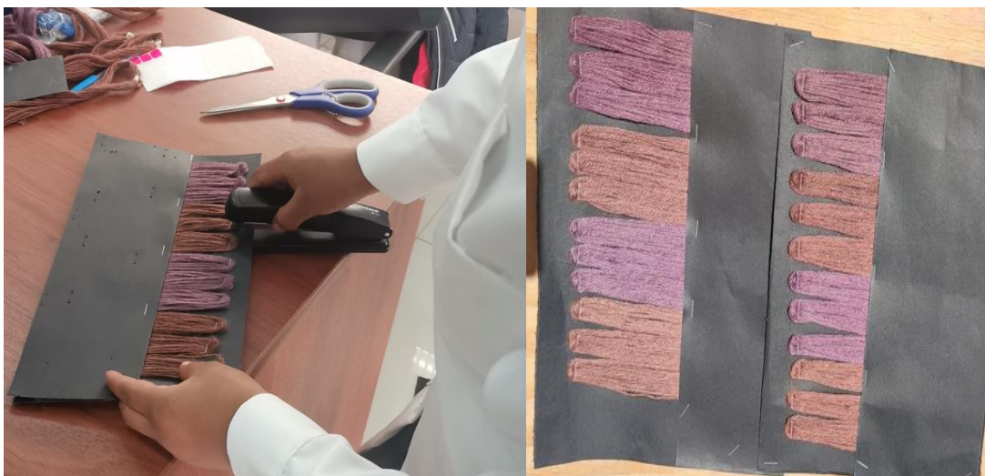
Preparación de las muestras y realización de la prueba de solidez de color a la luz.
