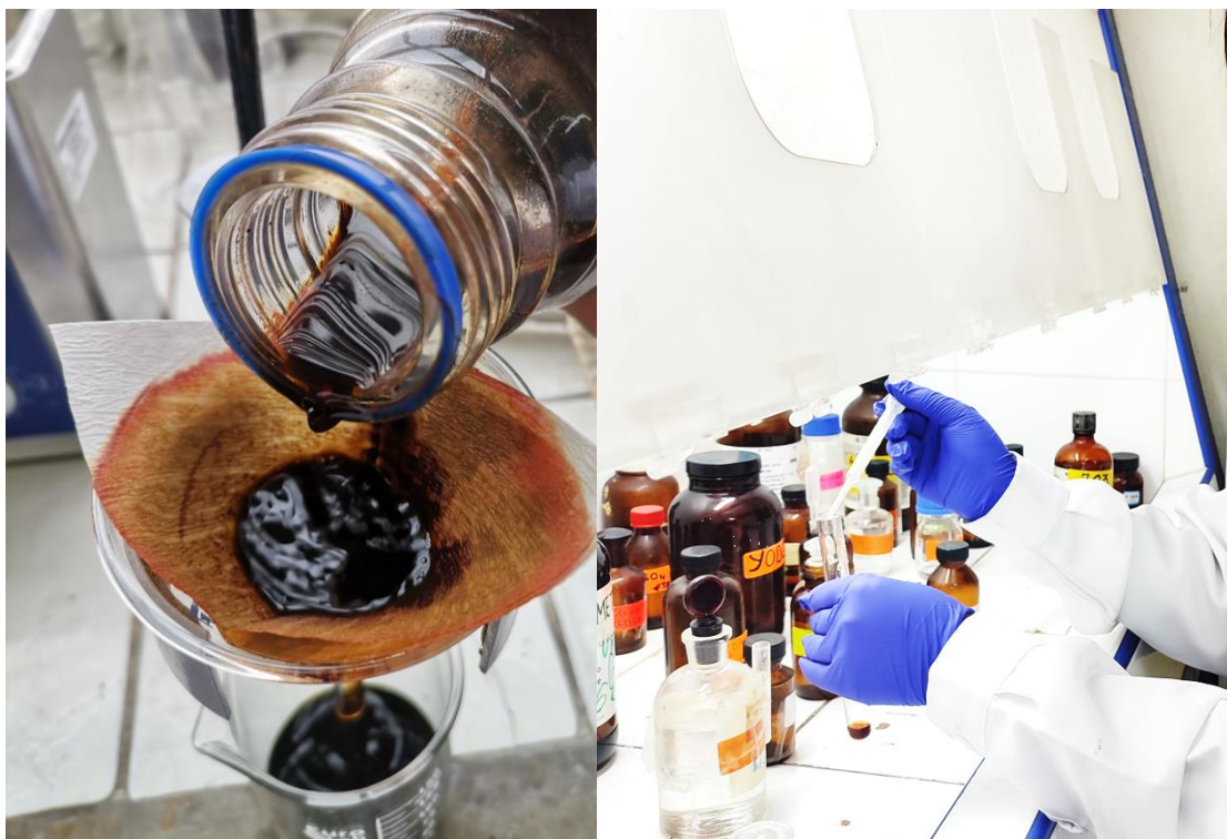
Filtración del sustrato de las hojas de ayapira ( Picramnia sellowii Planch) y colocación del reactivo correspondiente para la evaluación del metabolito secundario.
