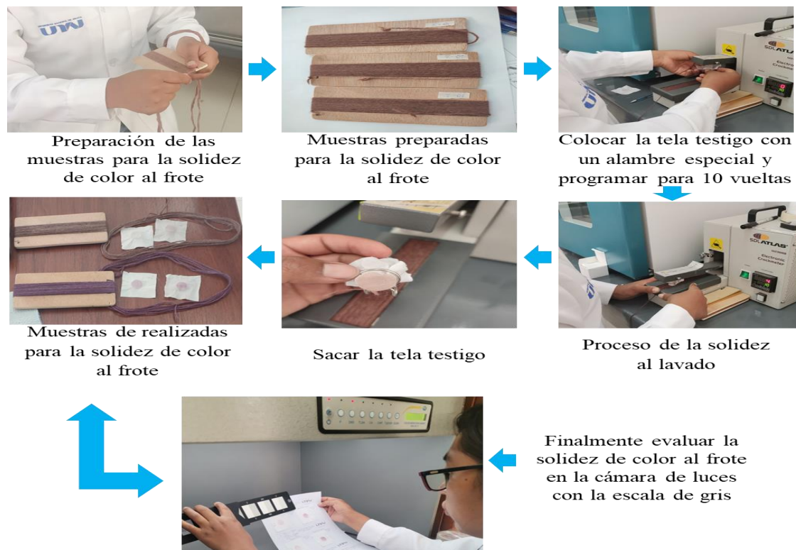
Figura 20: Secuencia fotográfica de pruebas de solidez de color al frote.
