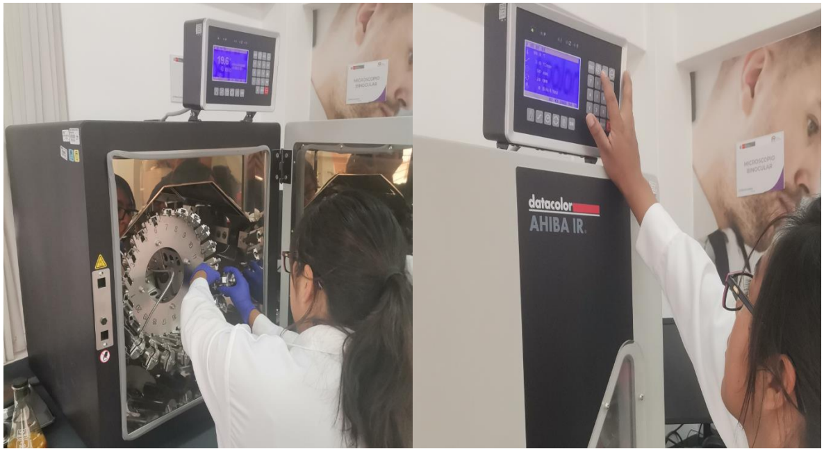
Distribución de los envases para el teñido en el equipo datacolor y la programación los parámetros del tiempo y temperatura.
