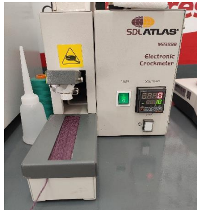
Figura 7: Crockmeter (Frictometro) M238BB Electronic Crockmete.
