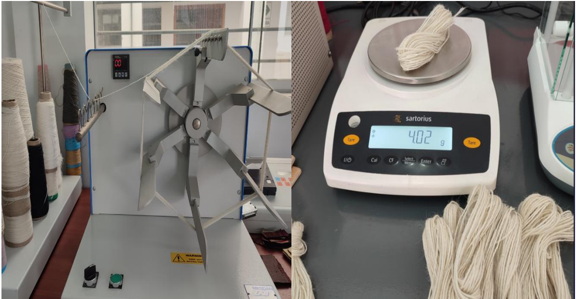
Realización de las muestras de madejas en el equipo (14 vueltas) y el pesado de cada muestra.
