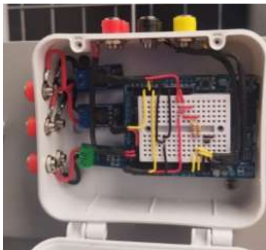
Conexión de Arduino R4 wifi y sensores
