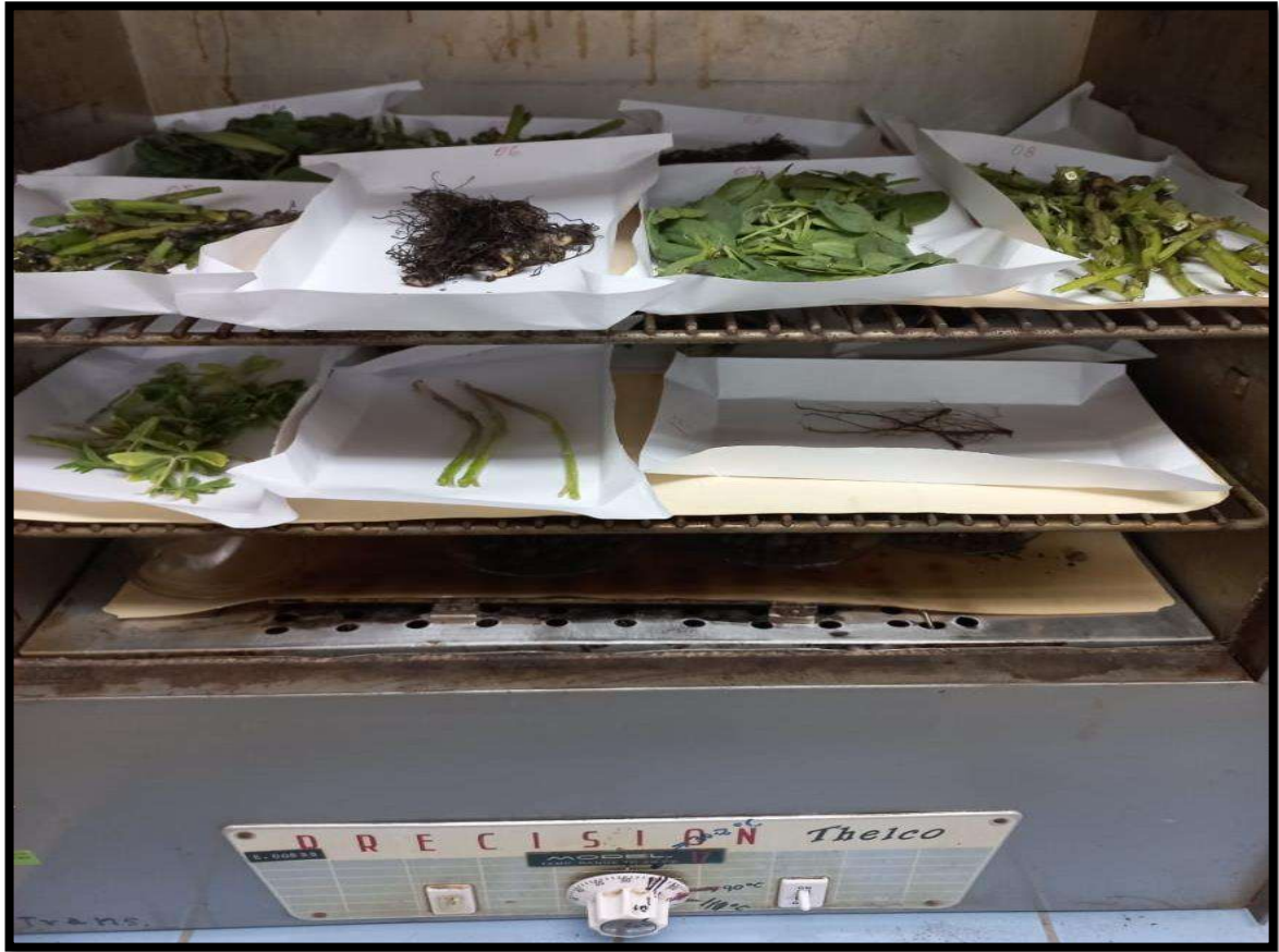
Figura 39 Secado de las muestras en estufa para luego enviar al laboratorio para su análisis de concentración de Cadmio de las especies de Vicia faba y Lupinus mutabilis
