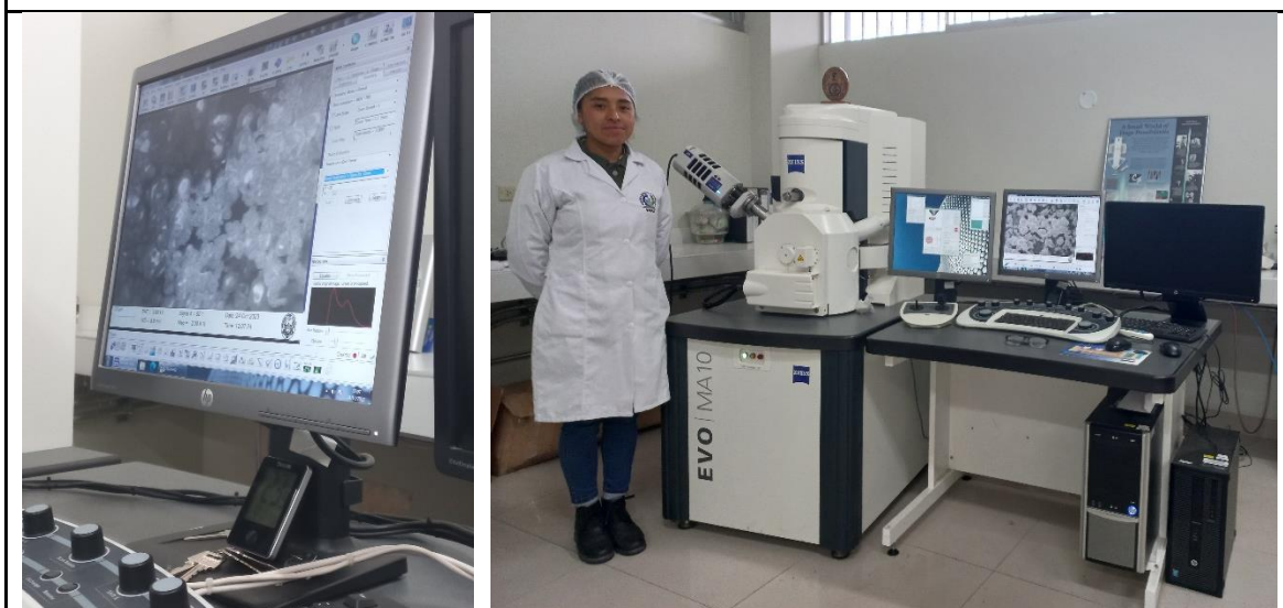
Análisis de las microcápsulas del aceite esencial de cedrón en el SEM.
