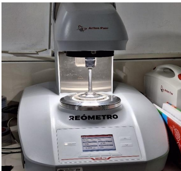
Figura 39: Procedimiento de carga de la muestra en el reómetro Anton Para.
