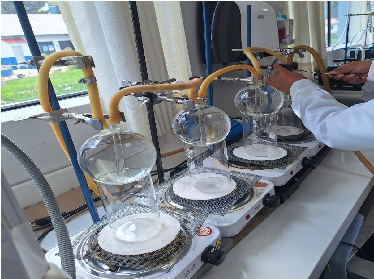
Figura 45: Sistema de digestión para la determinación de proteína.
