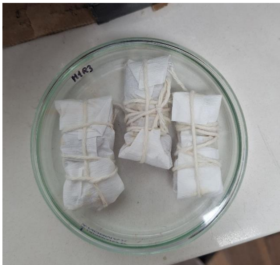
Figura 44: Proceso de desgrasado por el método de extracción Soxhlet.
