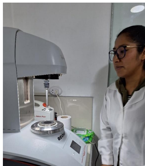
Figura 39: Procedimiento de carga de la muestra en el reómetro Anton Para.
