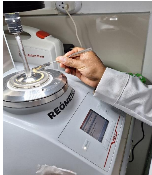
Figura 38: Preparación de muestra, para las corridas en el reómetro Anton.
