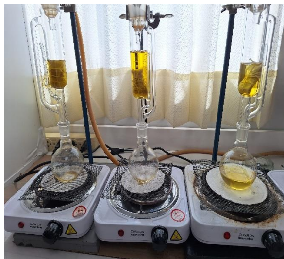
Figura 44: Proceso de desgrasado por el método de extracción Soxhlet.
