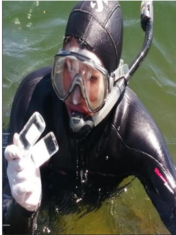
Figura 21. Toma de muestra de agua con la botella Winkler para fijación de muestras.
