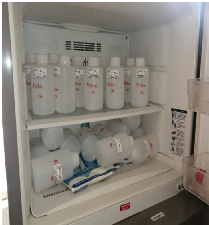
Figura 26. Preservación de las muestras de Nitrógeno total y fósforo para su envío al Laboratorio BHIOS.
