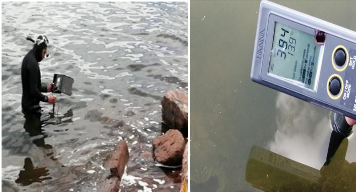
Figura 20. Medición de pH, temperatura, conductividad eléctrica con el Multiparámetro HI991300 marca HANNA en los puntos donde se encontró la presencia de Telmatobius culeus .
