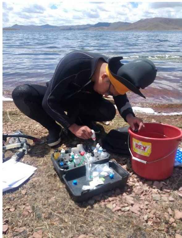
Figura 22. Medición del oxígeno disuelto mediante la metodología de la Global Water Watch (GWW) basado en Association Health American Public.1992 APHA- AWWA.
