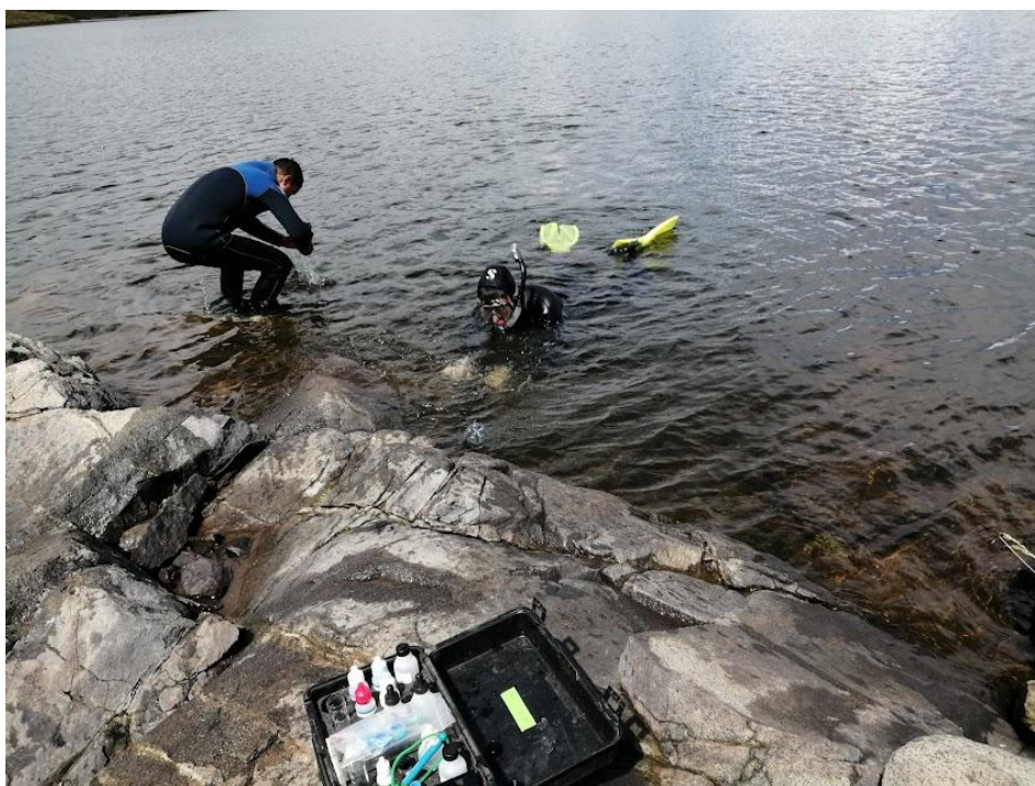
Figura 23. Medición de la Dureza mediante el método volumétrico procedimiento de la Global Water Watch (GWW) basado en Association Health American Public.1992 APHA- AWWA.
