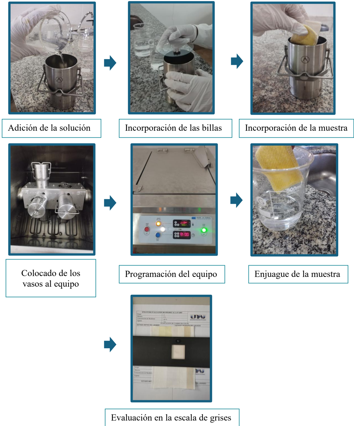
Figura 16. Procedimiento de evaluación de solidez de color al lavado
