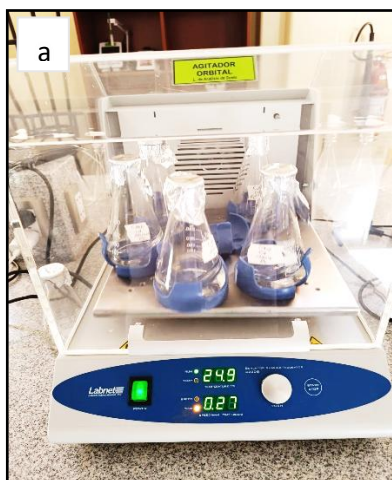
Foto 11. a) Prueba de adsorción - efluente, b) Filtrado después de las pruebas de adsorción.
