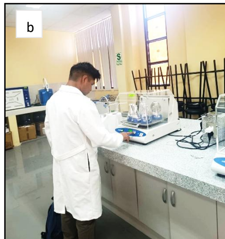
Foto 08. a) Pesaje de OG para cinética e isothermas, b) Pruebas de adsorción cinética.
