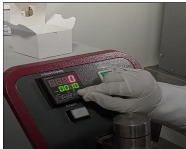
A10.3. Programación de número de vueltas según NTP para ensayo de solidez al frote.
