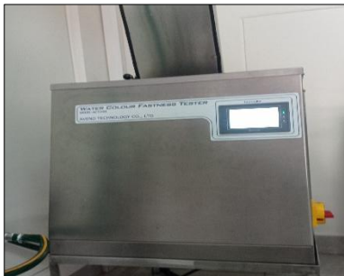
A12.3. Máquina Launderometro (wáter colour fastness tester) marca SAMKOON.
