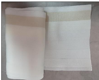
A14.3. Tela multifibra N°42 6 franjas (lana, acrílico, poliéster, nylon, algodón y acetato) usado para ensayo de solidez al lavado.
