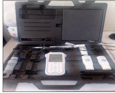
A12.8. Medidor portátil de pH marca (LOQUAact).
