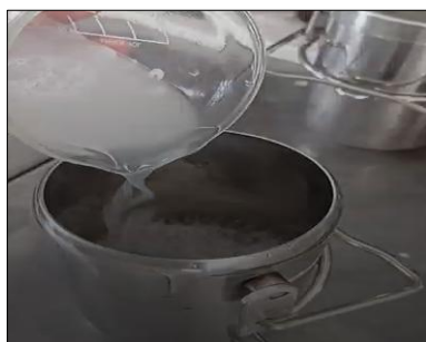
A9.3. Vertido solución (agua + detergente), agregar las esferas de acero inoxidable.
