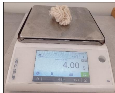
A7.2. Pesado de muestras de hilado de lana, en promedio 4g por madeja.
