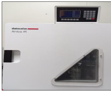
A12.1. Máquina de teñido de muestras marca (SGS(USTC) modelo AHIBA IR).
