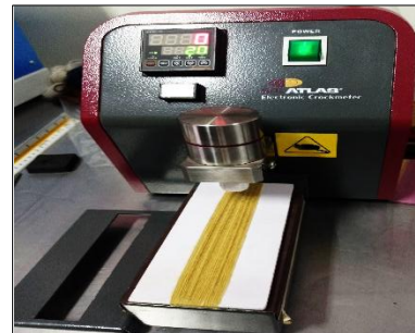
A12.4. Equipo Electronic Crockmeter marca (SDL ATLAS).
