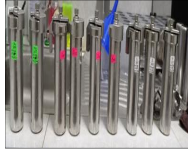
A8.8. Desajuste de recipientes de acero inoxidable para retirar las muestras teñidas.
