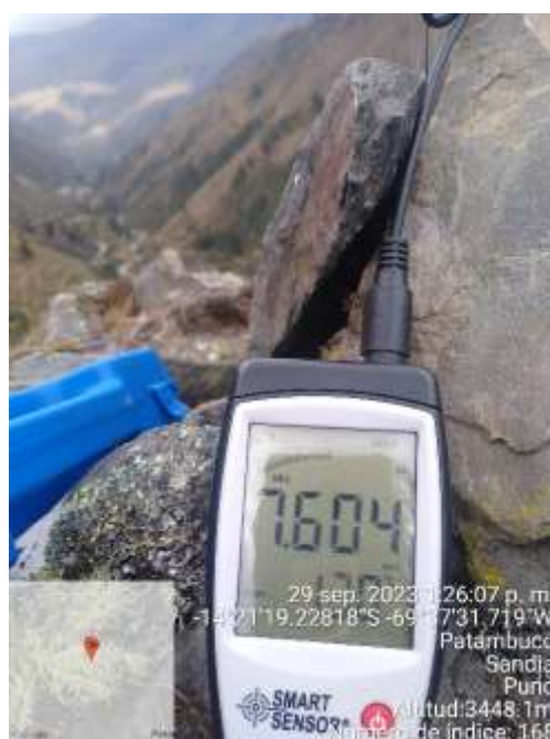
Figura 23. Medición directa de velocidad de viento – septiembre 2023.
