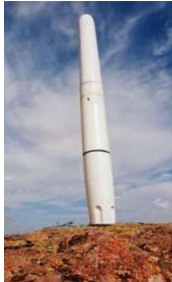
Figura 14. Modelo Vortex Tacoma 2,75m. Valle de Ambés (OMPI, 2024).
