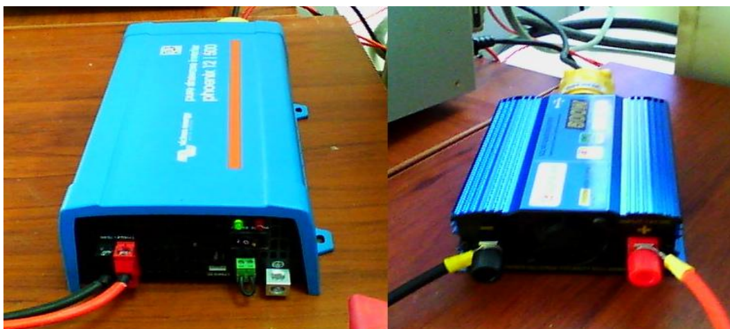
Figura 72. Inversor de alta y baja frecuencia en medición de la temperatura de prueba Nota. Se muestra los inversores de prueba en el laboratorio de energía fotovoltaica (Fuente propia).
