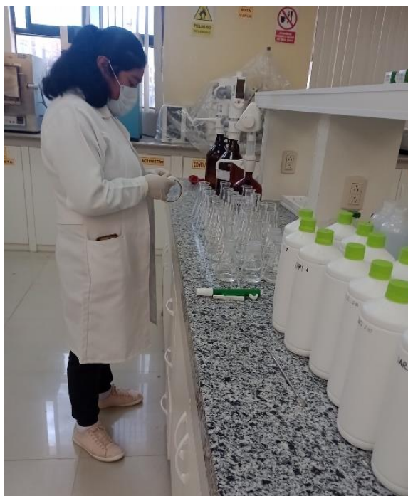
Figura 15. Titulación de muestras de aguas subterráneas y superficiales, para la determinación de carbonatos.
