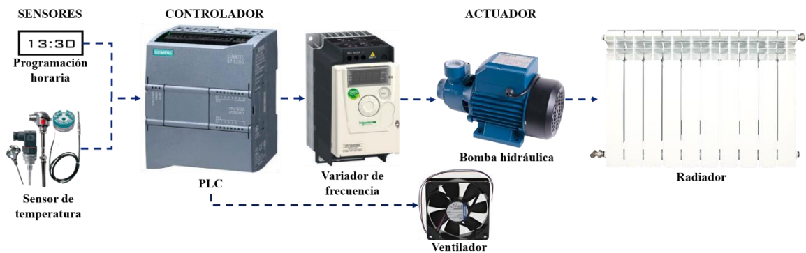
Figura 32. Diagrama de interacción del PLC con los componentes del sistema de control.
