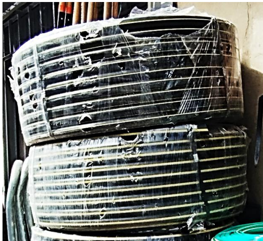
Figura 13. Tubería de 100 m polietileno, adaptación propia.
