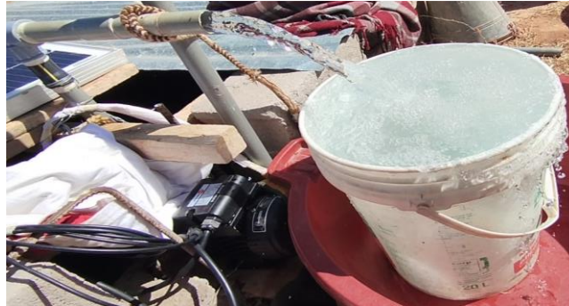
Figura 28. Evaluación experimental del caudal de las bombas solares.
