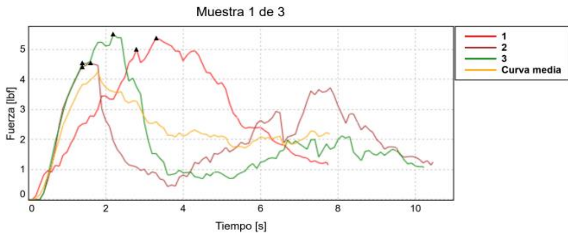
Anexo 52: Figura de la textura (Dureza y fracturabilidad) de la galleta Testigo al 100% de Margarina
