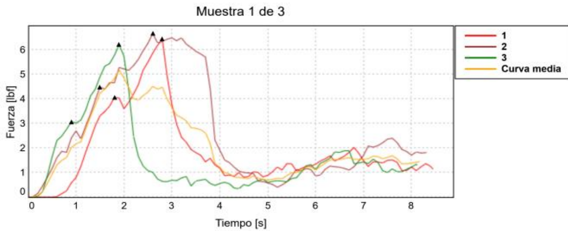
Anexo 52: Figura de la textura (Dureza y fracturabilidad) de la galleta Testigo al 100% de Margarina
