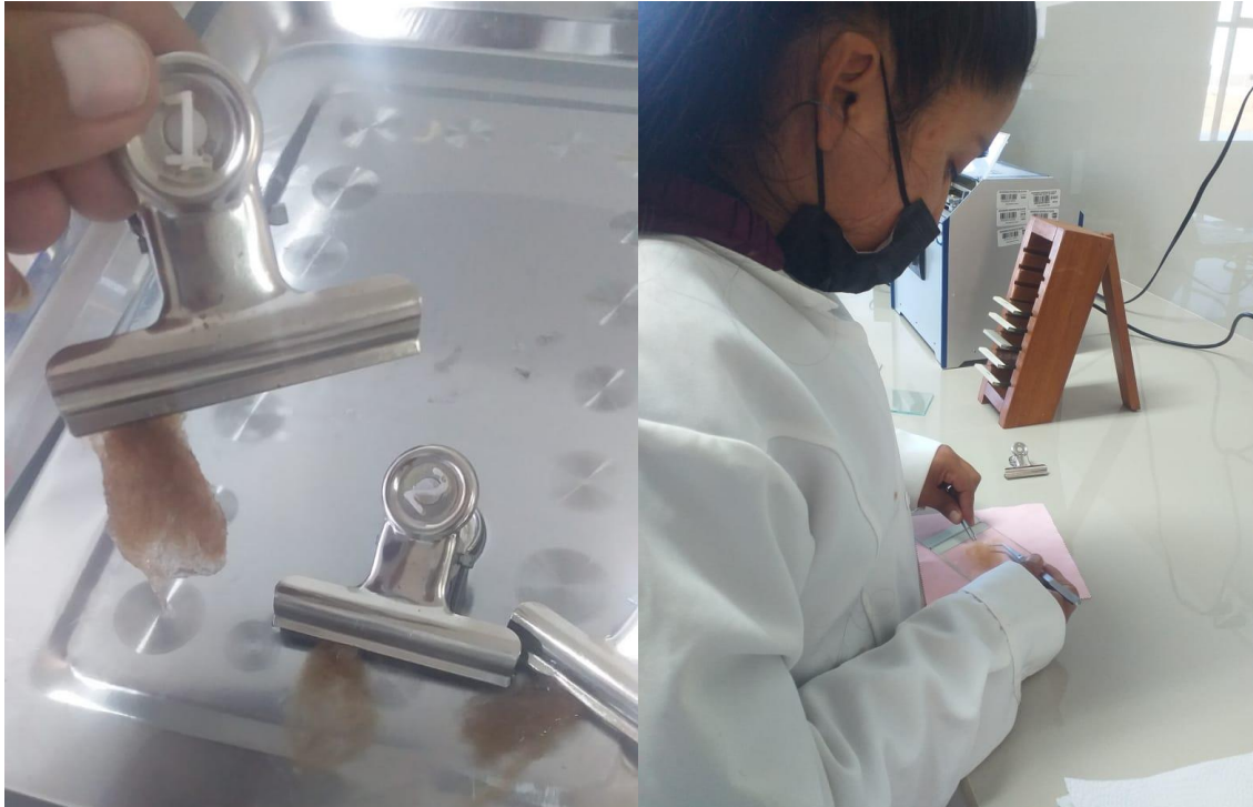
Figura 18: Acondicionamiento de las muestras de fibra de vicuña para su análisis
