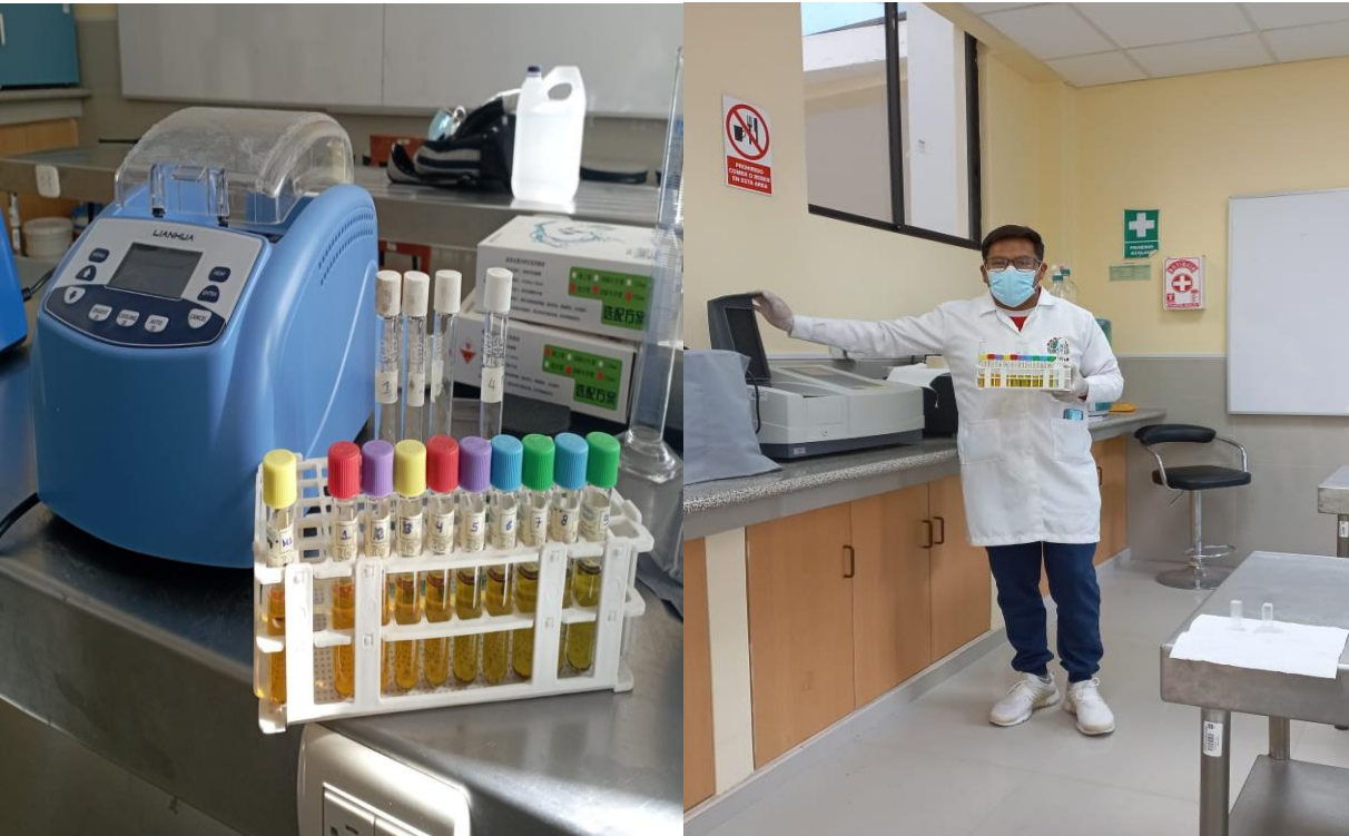
Figura 22. Lectura de viales digeridos para determinación de la DQO mediante absorbancia en el espectrofotómetro UV
