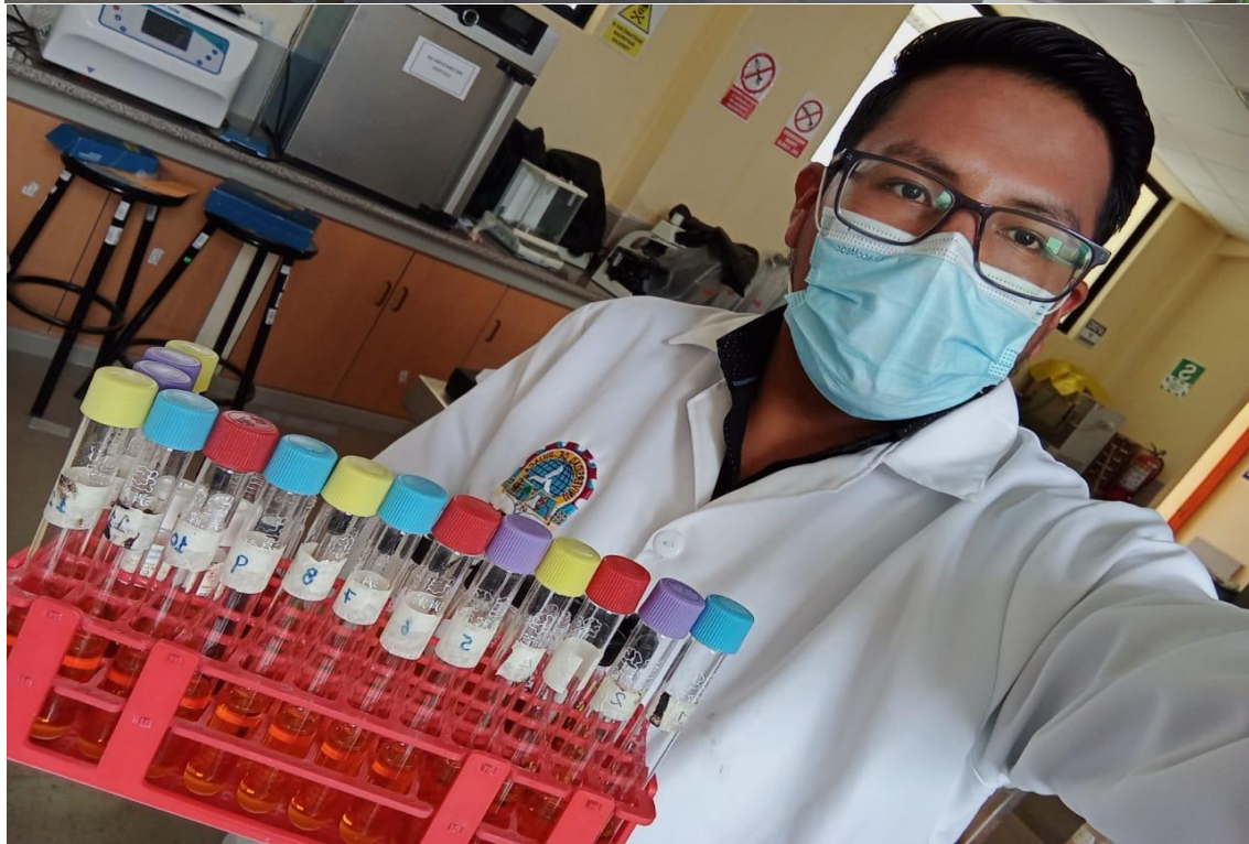
Figura 21. Preparación de solución digestora y viales para determinación de DQO
