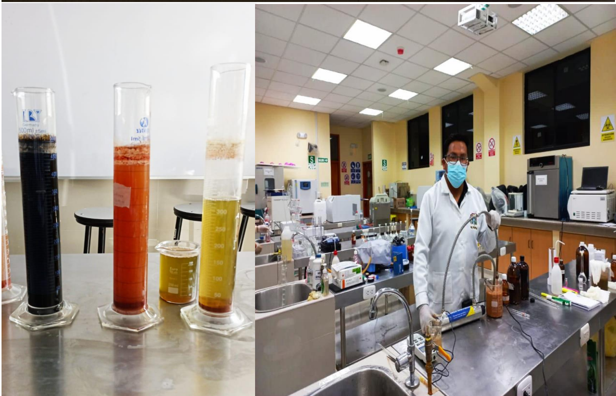
Figura 20. Calidad de las muestras luego del tratamiento de oxidación foto-fenton
