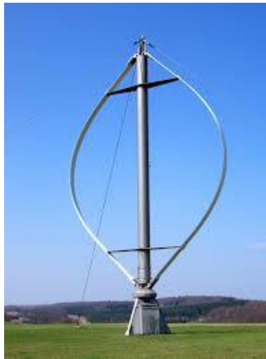
Figura 18. Aerogenerador tipo Darrieus (AeroGeneradores, 2022)
